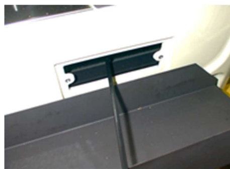
Abbildung Nr.18 - Zugänge zum Reinigen des Rauchabzugs.
