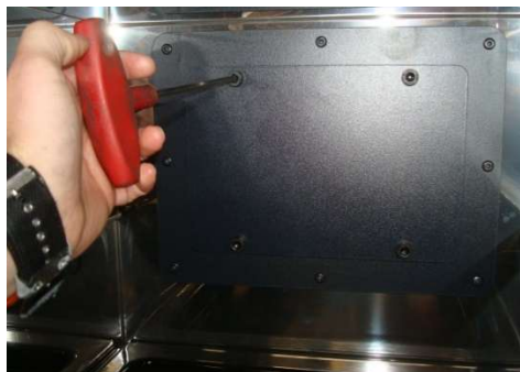
Abbildung Nr.17 - Zugang zu den Schrauben zum Entfernen des Lukendeckels.
