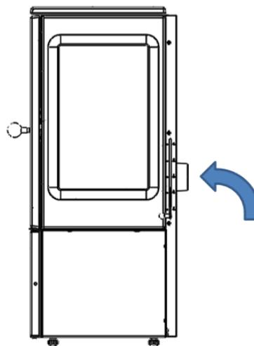
Abbildung Nr.10- Luftkanal für die Brennkammer, Garde
