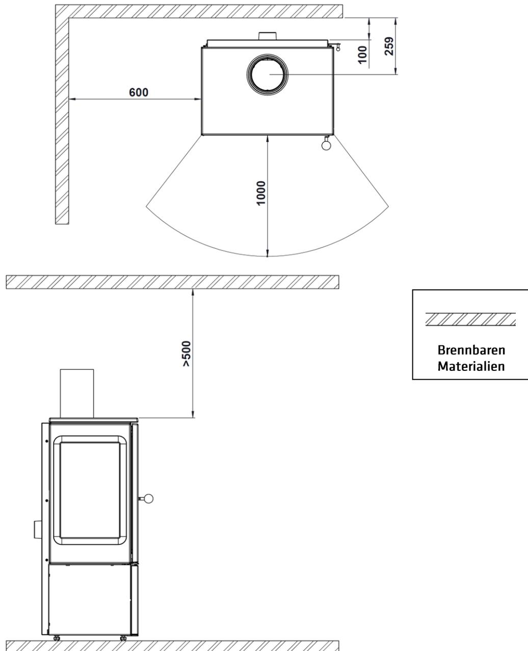
Beachten Sie, dass es notwendig sein kann, nicht brennbare Materialien zu schützen, um Bruch, Verformung usw. aufgrund von Übertemperatur zu verhindern, wenn das nicht brennbare Material nicht bereit ist, hohen Temperaturen standzuhalten.
