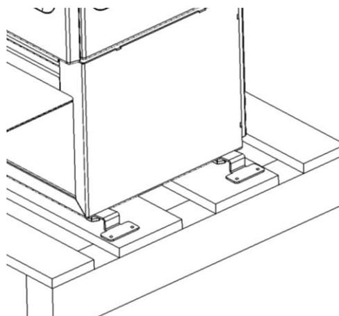
Abbildung Nr.6 - Detail der Platten, die den Ofen am Holzsockel befestigen
