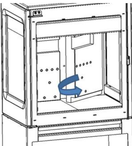
Entfernen Sie die "rechte hintere Platte" (2). Heben Sie sie zuerst über den Sockel
