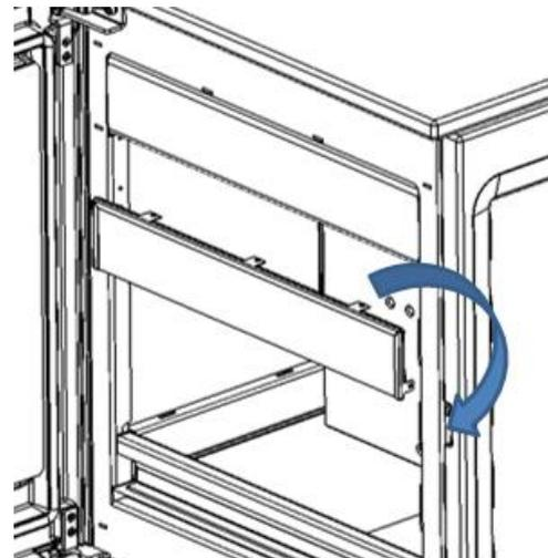
Entfernen Sie das "Sekundärluftrichtungsglas" (6).
