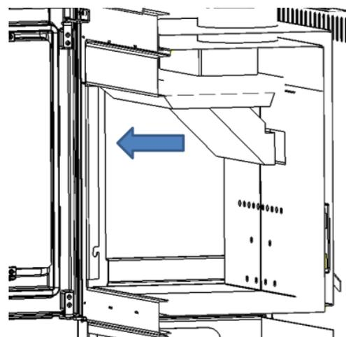
Entfernen Sie das "untere Ablenklech" (3), indem Sie das obere Ablenklech (4)
