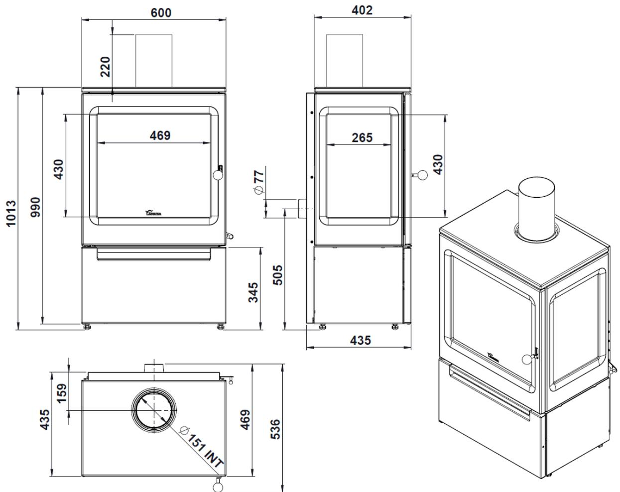
Abbildung Nr.1 - Abmessungen des Geräts in mm Garde
