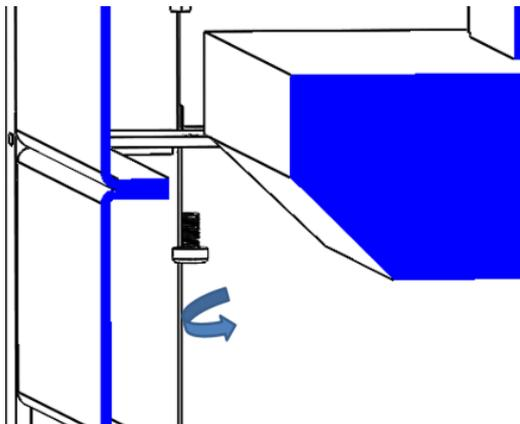
Lösen Sie die 2 Schrauben auf beiden Seiten des "oberen Ablenkers" (4), die dessen Bewegung verhindern.
