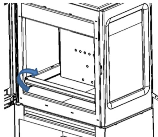
Entfernen Sie das "Kipp-Abstandsstück" (7), indem Sie es in das Innere des Feuerraums drehen.
