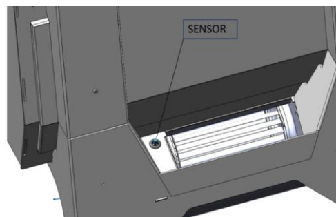
Figura n°12 - Position der Temperatursonde (SENSOR) am Turbinenluftaustritt
