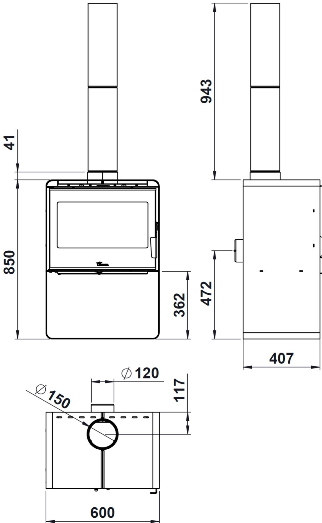
Abbildung 1 Abmessungen des Geräts in mm Ocean/Atlantic 603
