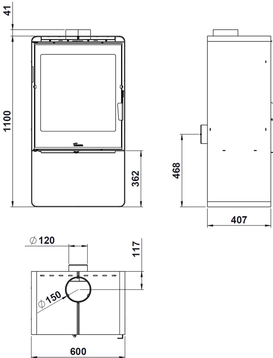
Abbildung 2 Abmessungen des Geräts in mm Ocean/Atlantic 613
