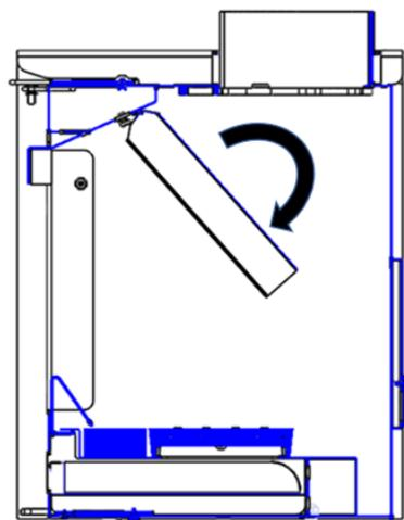
Abbildung 6 Drehen und Entfernen des oberen Stahlabweisers
