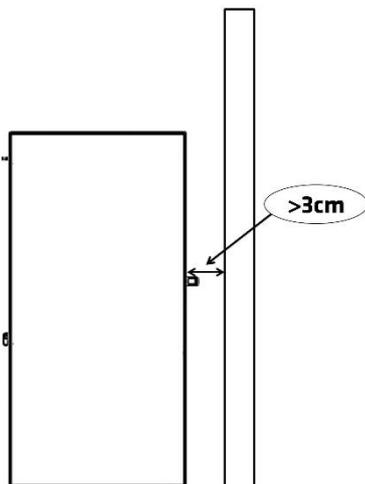
Abbildung 3- Abstand zwischen dem Gerät und der Rückwand
