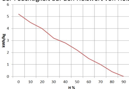
Abbildung 2 Beziehung zwischen Feuchtigkeit und Heizwert von Holz
