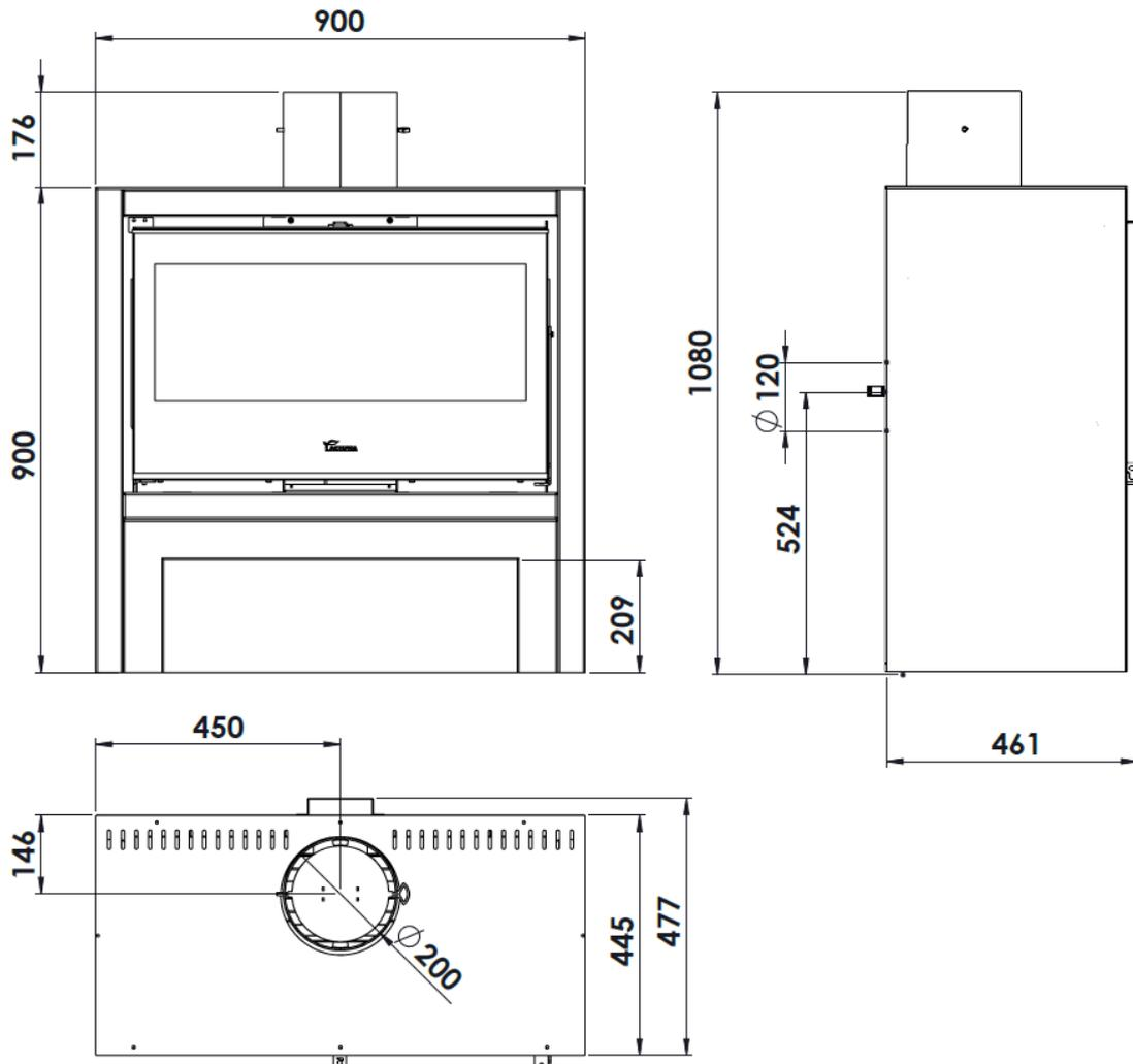
Abbildung 1 Abmessungen des Geräts in mm Platinum 800
