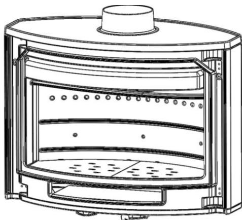
f- Entfernen Sie die Vermiculite (3), (4) und (5), indem Sie zuvor die Deflektoren an der Rückseite anheben
