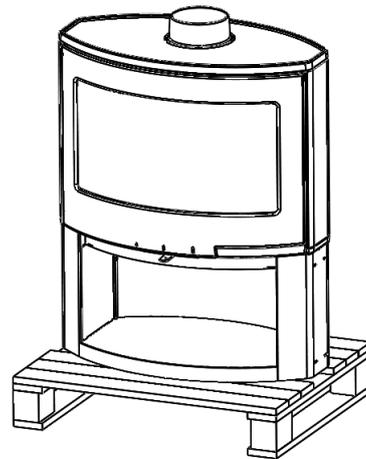
Abbildung Nr.5 - Herd nach Entfernen der Schutzverpackung
