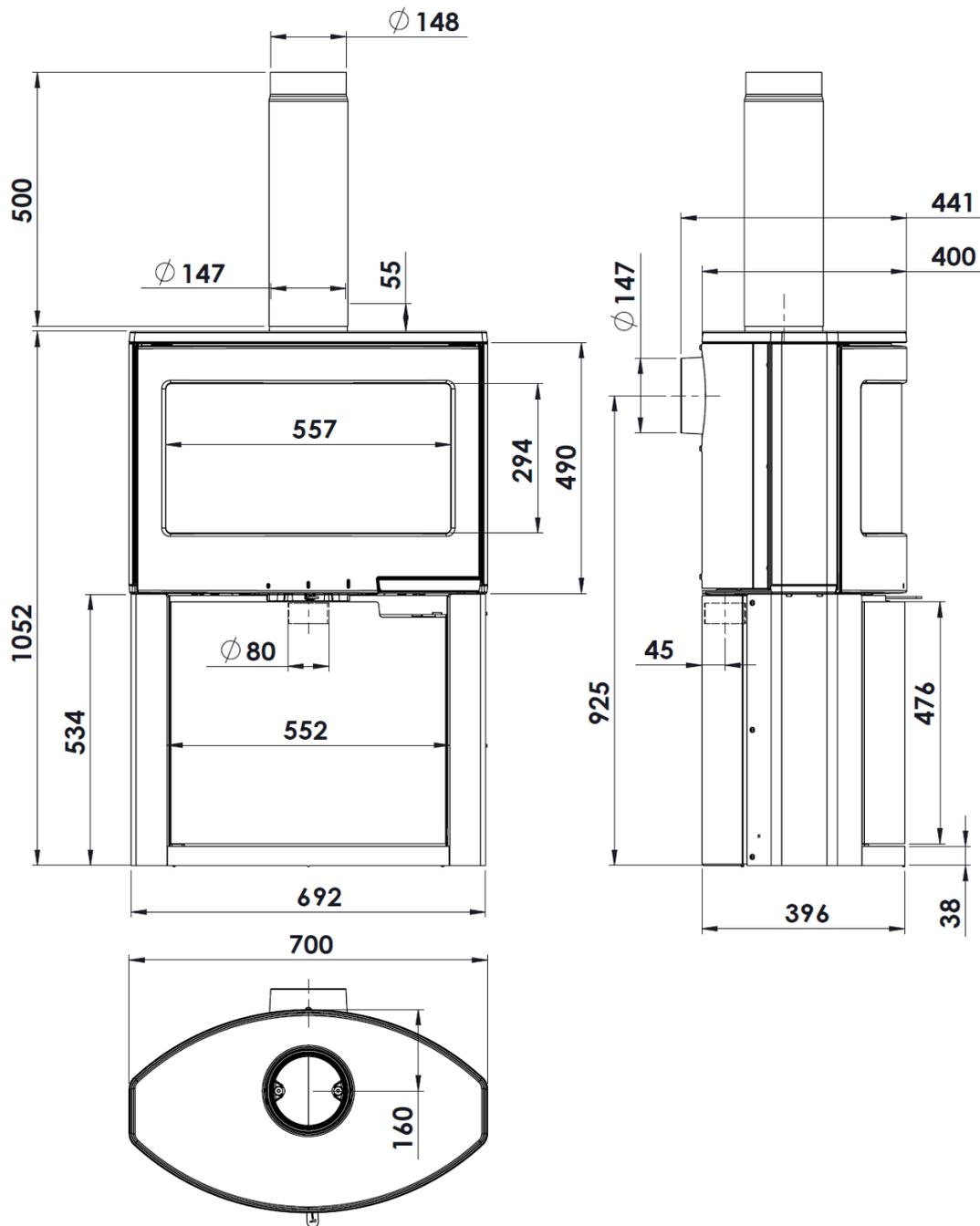
Abbildung Nr.3- Abmessungen des Geräts in mm Bera
