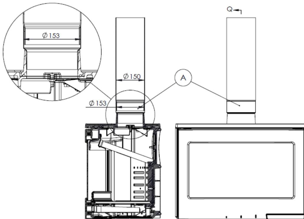
Abbildung Nr. 4 - Anschluss an den Schornstein ohne den mitgelieferten Adapter (A)
