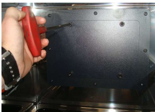
Figura n°17 - Acceso a los tornillos para retirar la tapa de la escotilla
