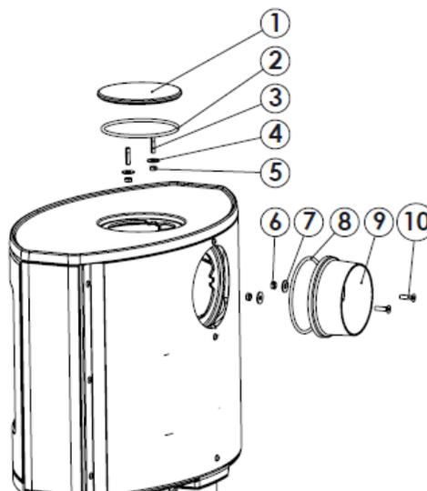
*Figura nº10 - Montaje tapa en parte superior y cuello de conexión en parte posterior.*
