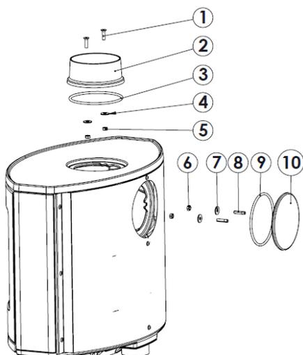
*Figura nº9 - Desmontaje tapa posterior y cuello de conexión superior*
