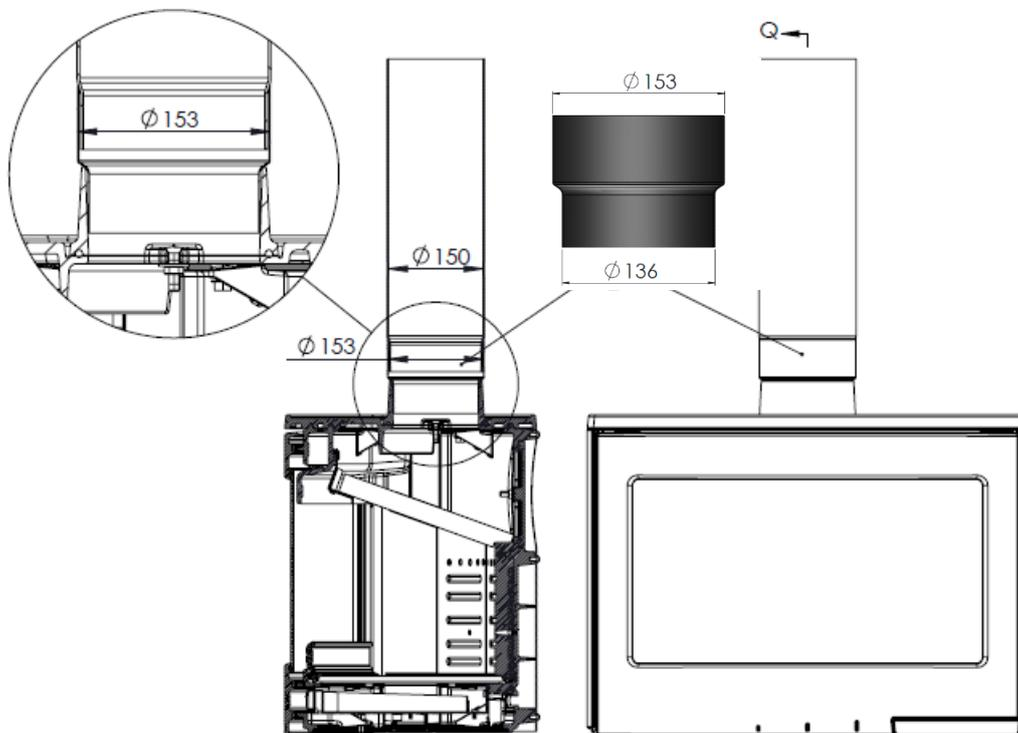
Figura nº4 - Conexión al conducto de humos con el adaptador (A) suministrado
