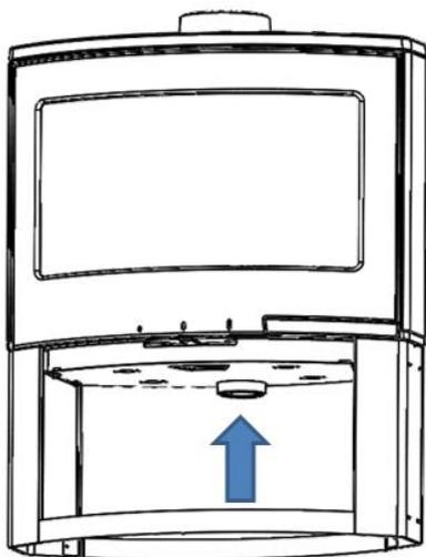
Figura nº11 - Entrada de aire para cámara de combustión
