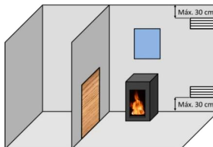
Figura nº5 - Esquema orientativo para rejillas de ventilación
