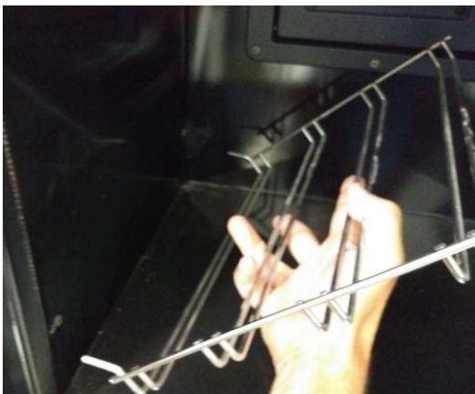
Figura nº22 - Retirada de los soportes de varillas.
