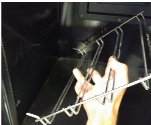
Figura nº22 - Retirada de los soportes de varillas.
