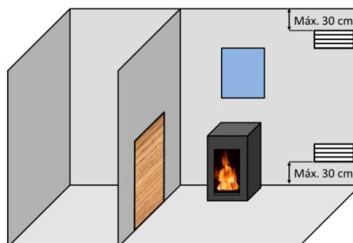
*Figura n°5 - Esquema orientativo para rejillas de ventilación*
