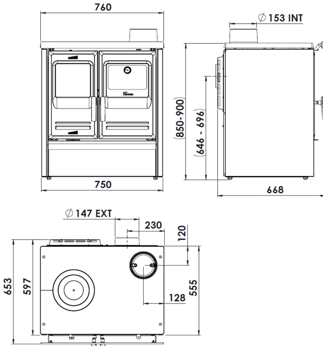
Figura nº1 - Dimensiones en mm del aparato ETNA 5T Salida SUP y Trasera
