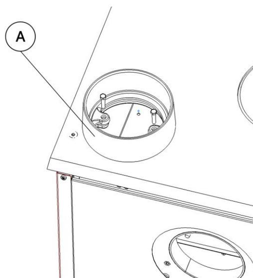
*Figura nº8 - Colocamos la brida salida de humos superior.*
