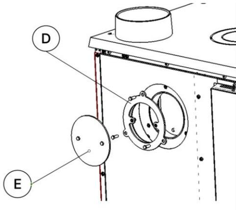
Figura nº9 - Colocamos el adaptador y la tapa.
