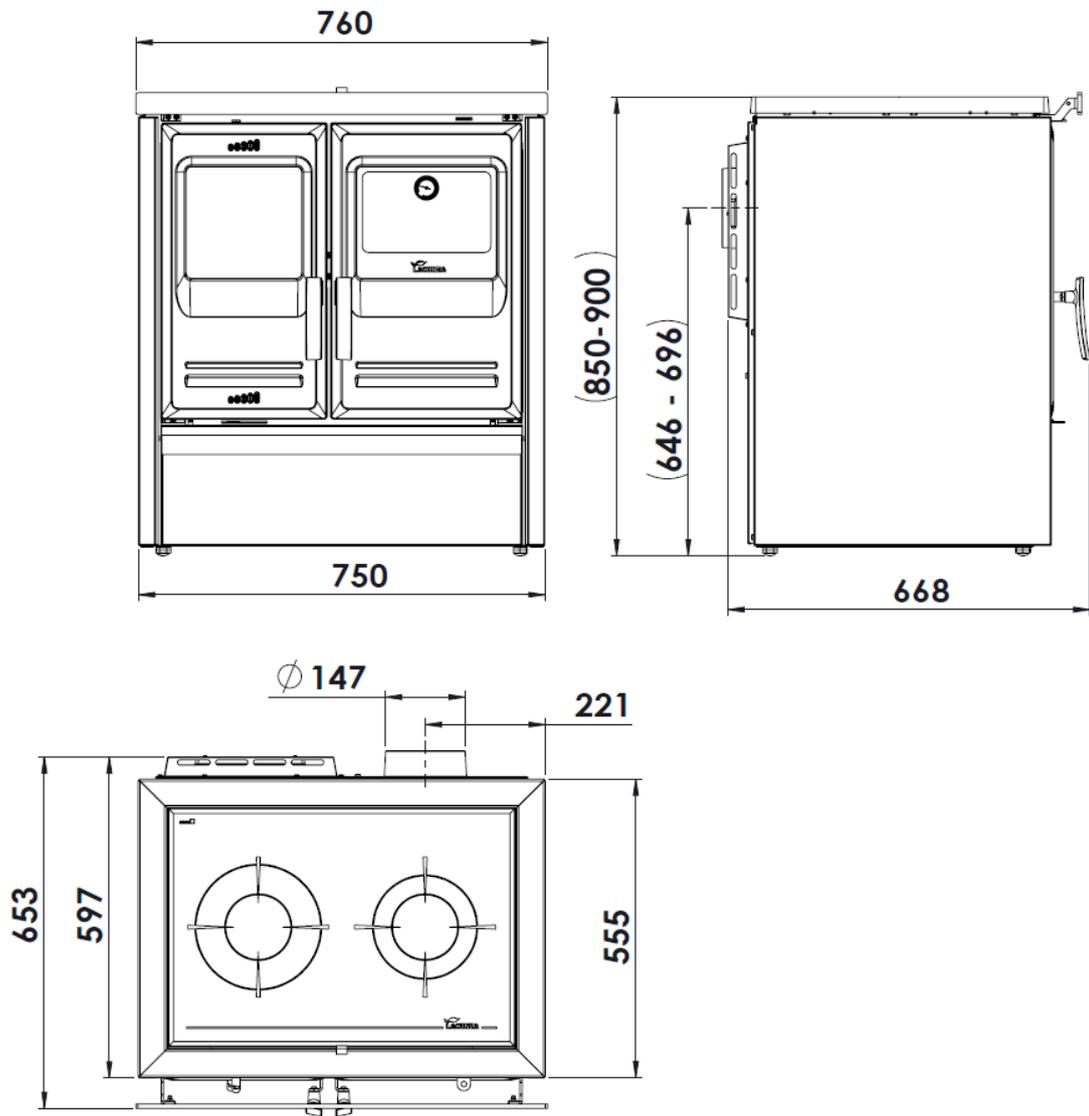
Figura nº2 - Dimensiones en mm del aparato ETNA 5T TOP
