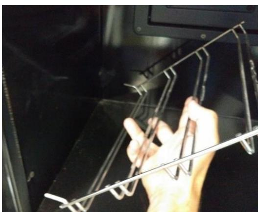
*Figura n°22 - Retirada de los soportes de varillas.*
