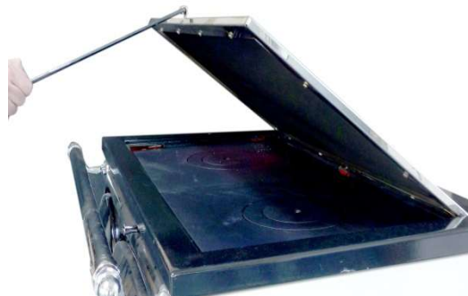
Figura nº19 - Acompañamiento del movimiento con el gancho
