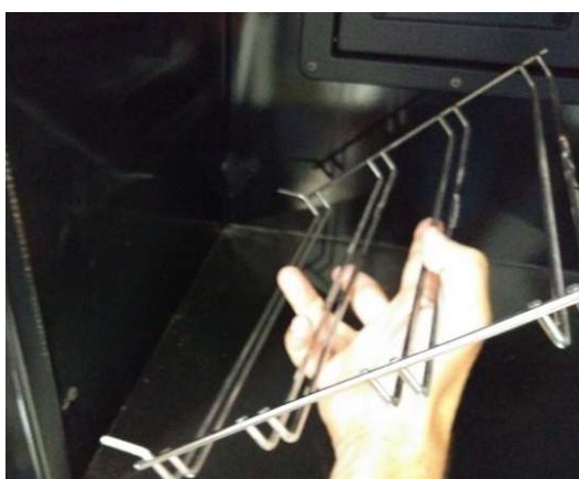
Figura nº23 - Retirada de los soportes de varillas.
