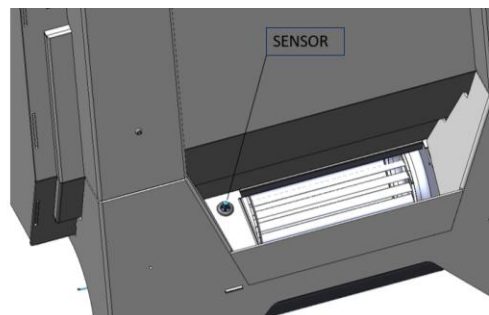
Figura n°21 - Posición de la sonda de temperatura (SENSOR) en la salida de aire de la turbina
