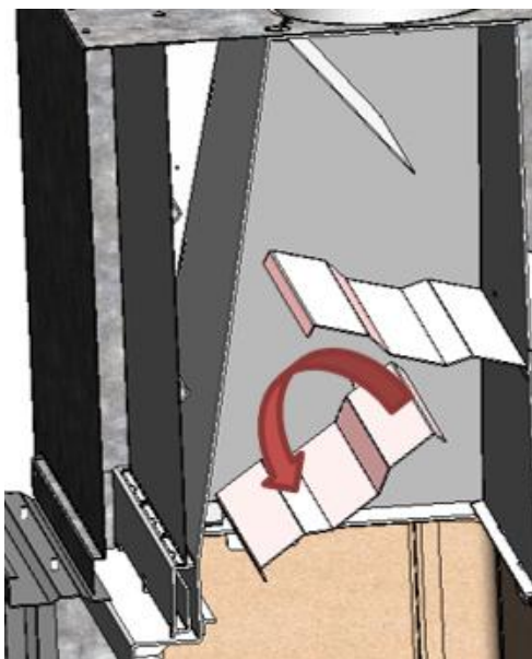
Figura n°32 - Desmontaje del deflector medio Itaca 80
