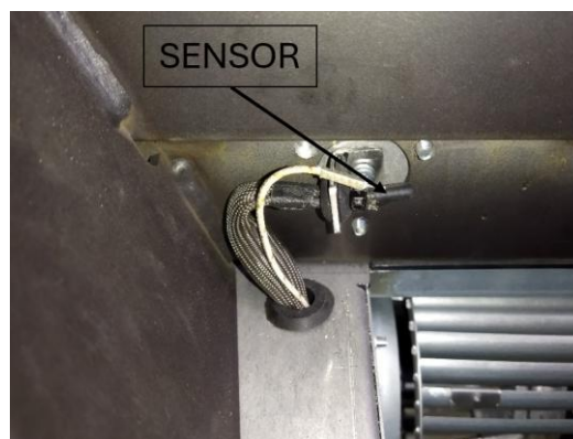
Figura n°24 - Posición de la sonda de temperatura (SENSOR) en la salida de aire de la turbina
