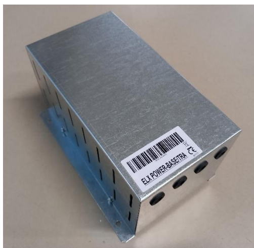
Figura n°21 - Módulo de potencia del regulador de aire automático ELX AIR POWER BASE/TRA.
