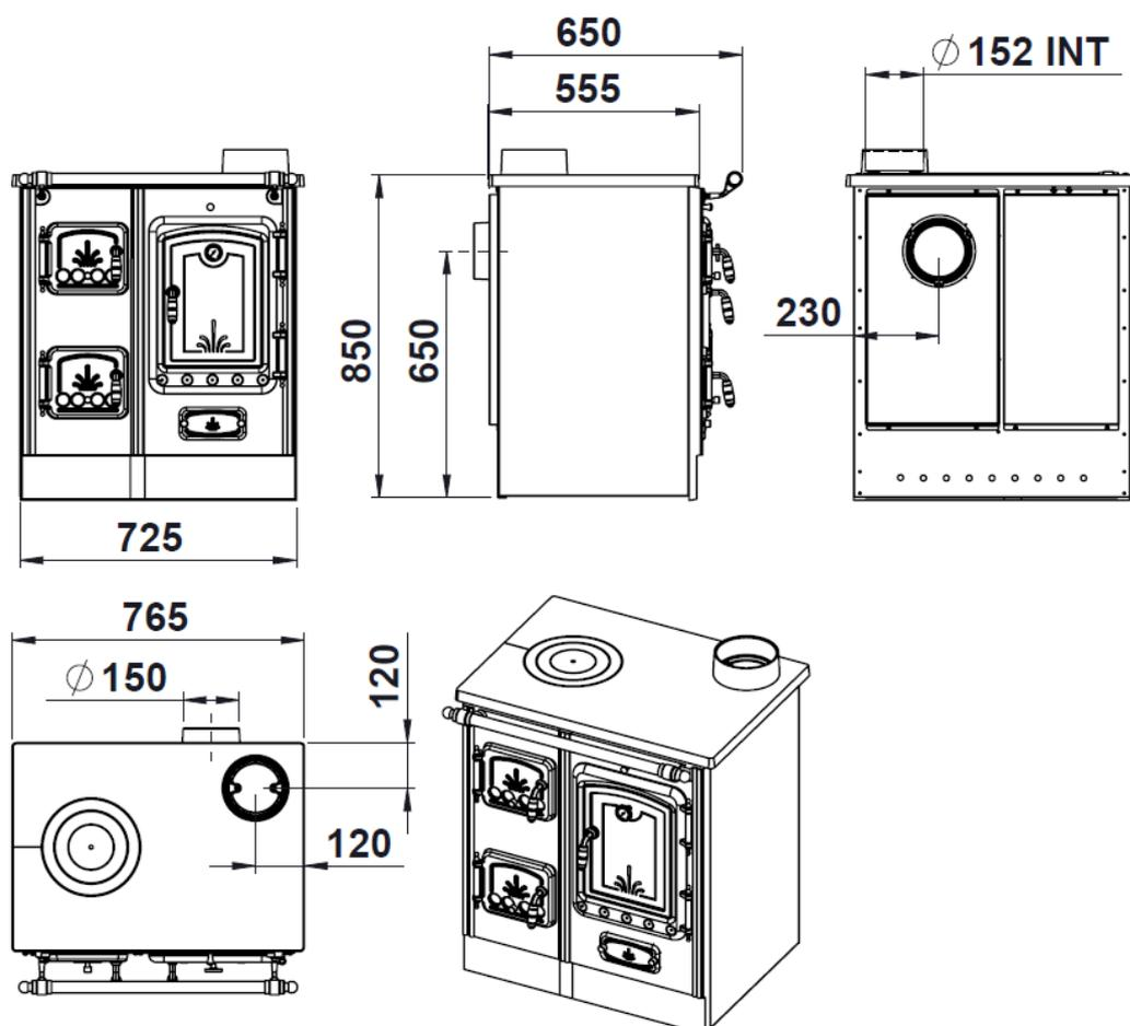
Figura nº1 - Dimensiones en mm del aparato Lis 5T
