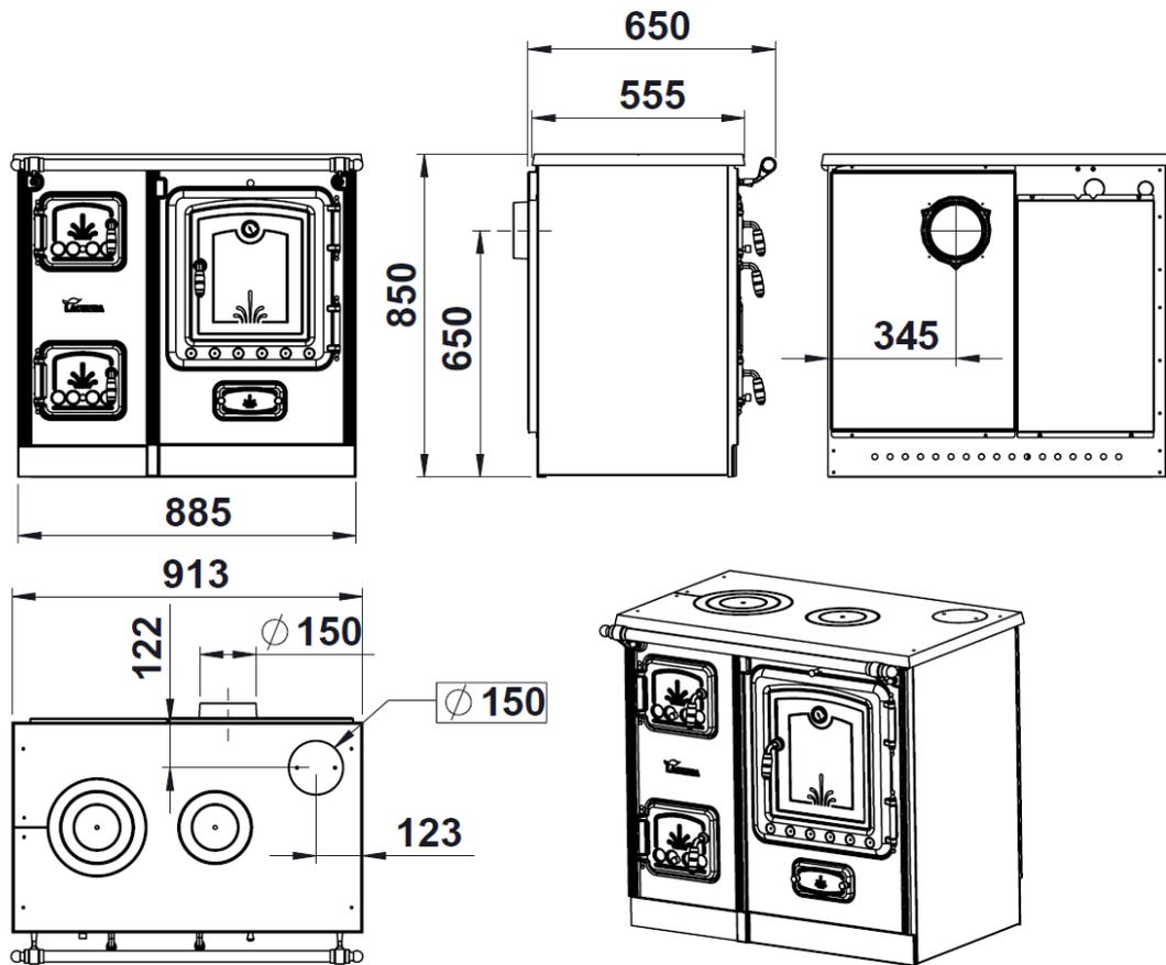
Figura nº2 - Dimensiones en mm del aparato Lis 7T
