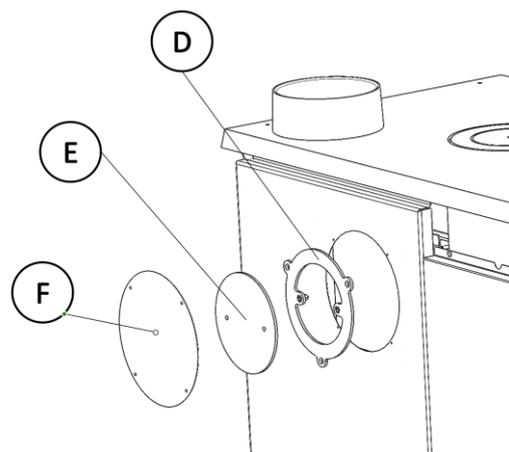
*Figura nº7 - Colocamos el adaptador y las tapas.*
