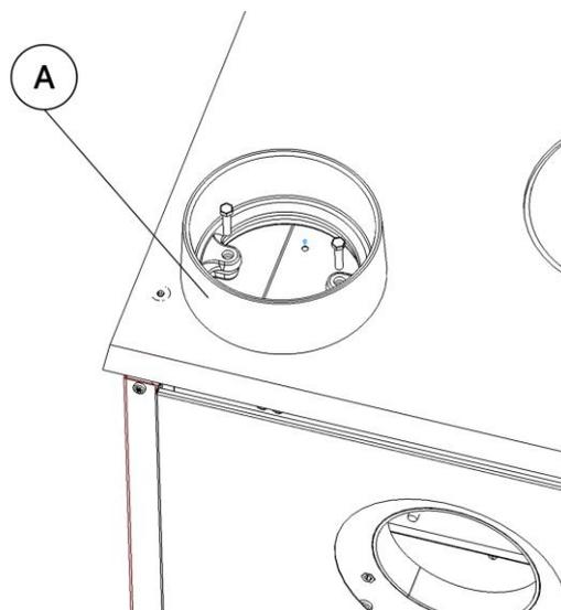
*Figura nº6 - Colocamos la brida salida de humos superior.*
