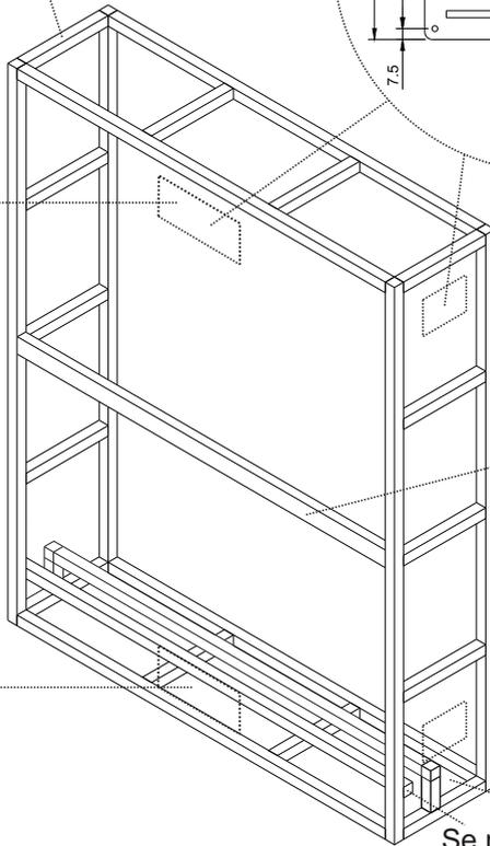
Las rejillas se pueden instalar en el frontal o en los lados de la estructura.
