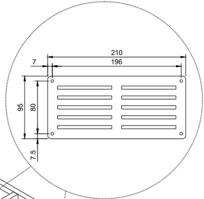
Se requiere ventilación en la parte superior e inferior, en el frontal o en los lados de la estructura.
