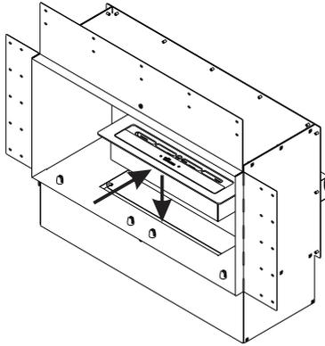
Coloque el quemador en el aparato.
