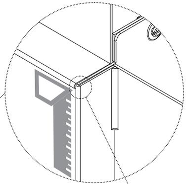
Alinee los bordes en todas las esquinas y apriete todos los tornillos para mantener la alineación de las esquinas.
