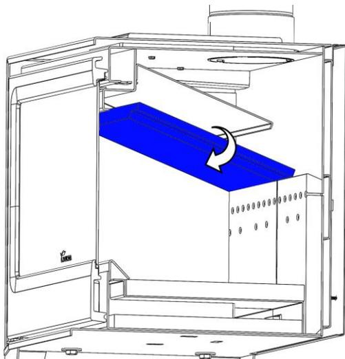
*Figura n°14 - Retirar vermiculita*
