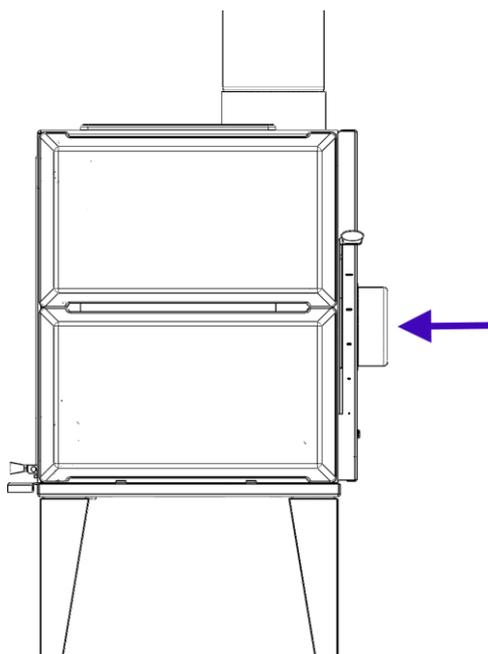
*Figura nº3 - Conducción de aire para cámara de combustión*
