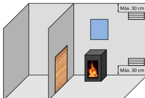
*Figura n°4 - Esquema orientativo para rejillas de ventilación*
