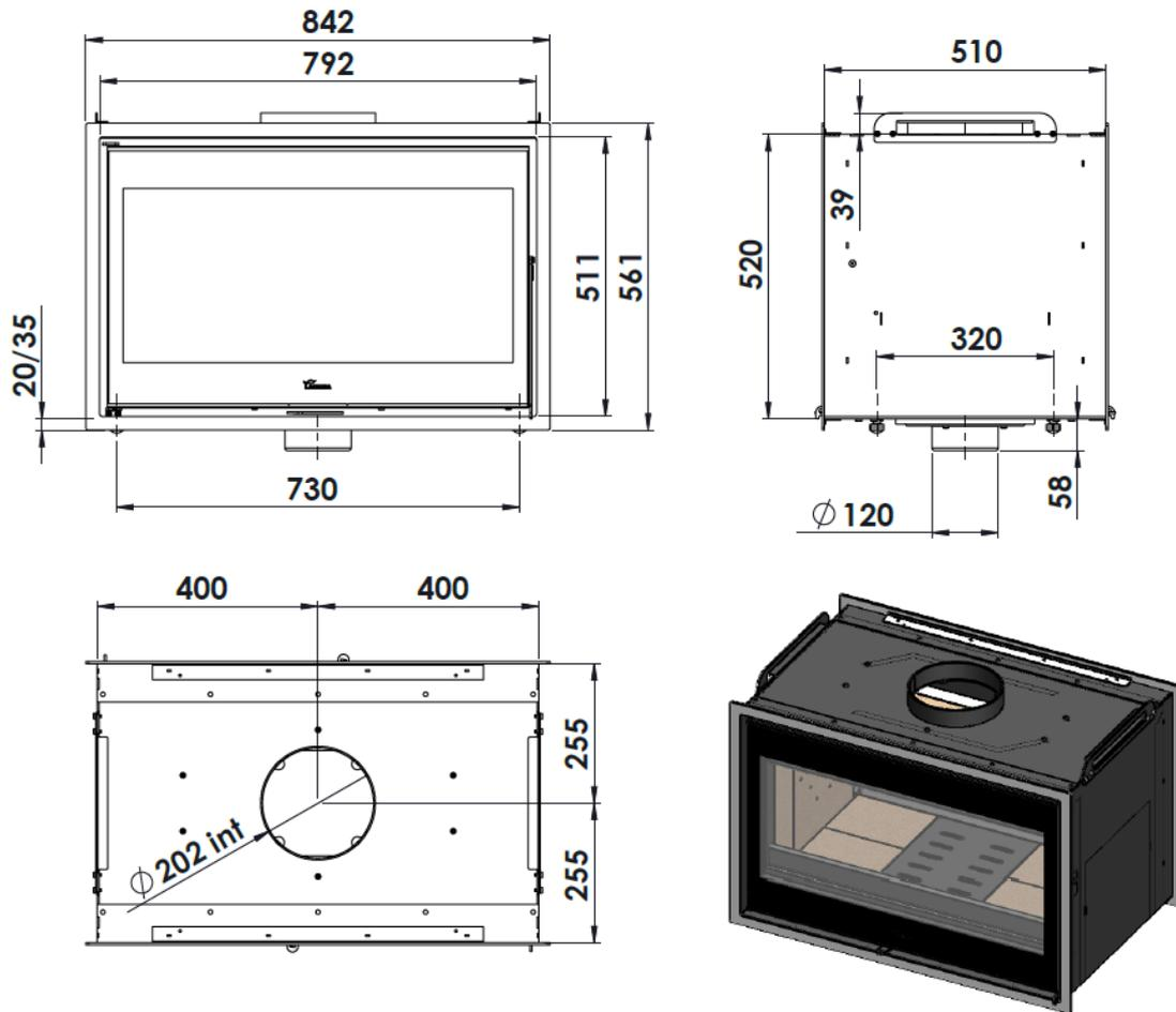
Figura n<sup>o</sup>2 - Dimensiones en mm del aparato Nickel 800
