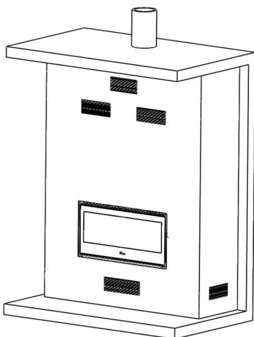
*Figura n<sup>o</sup>8 - Esquema exterior del cerramiento*
