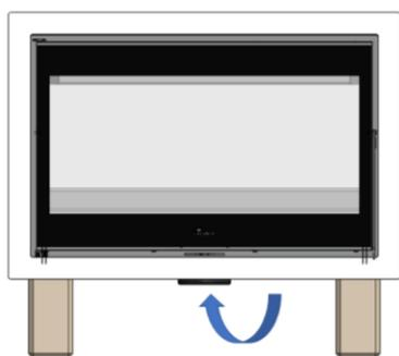
*Figura n°5 - Entrada del aire para la combustión*
