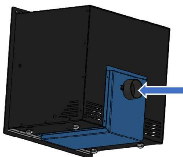
Figura nº13 - Accesorio para canalizar la entrada de aire desde la parte trasera
