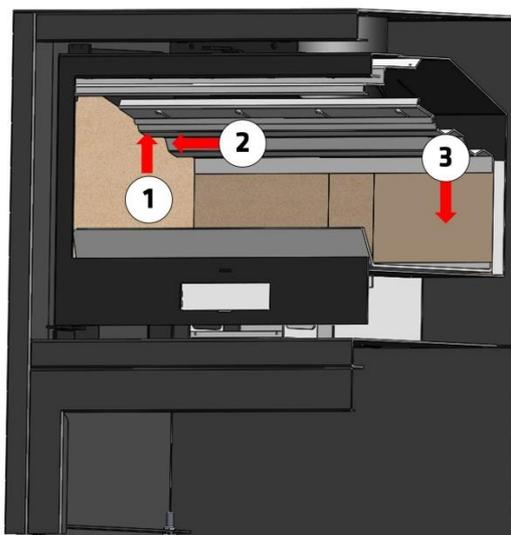
Figura nº10 - Desmontaje del deflector PLATINUM 800
