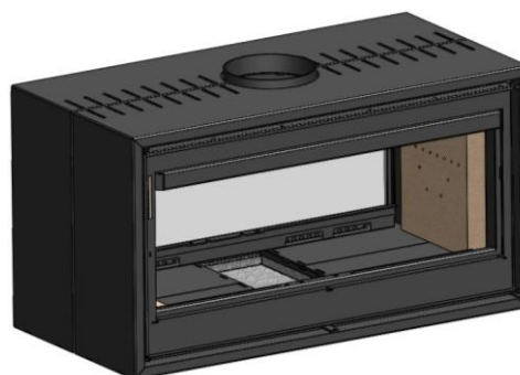
Figura nº21 - Extraer el refractario inferior restante del lado derecho.
