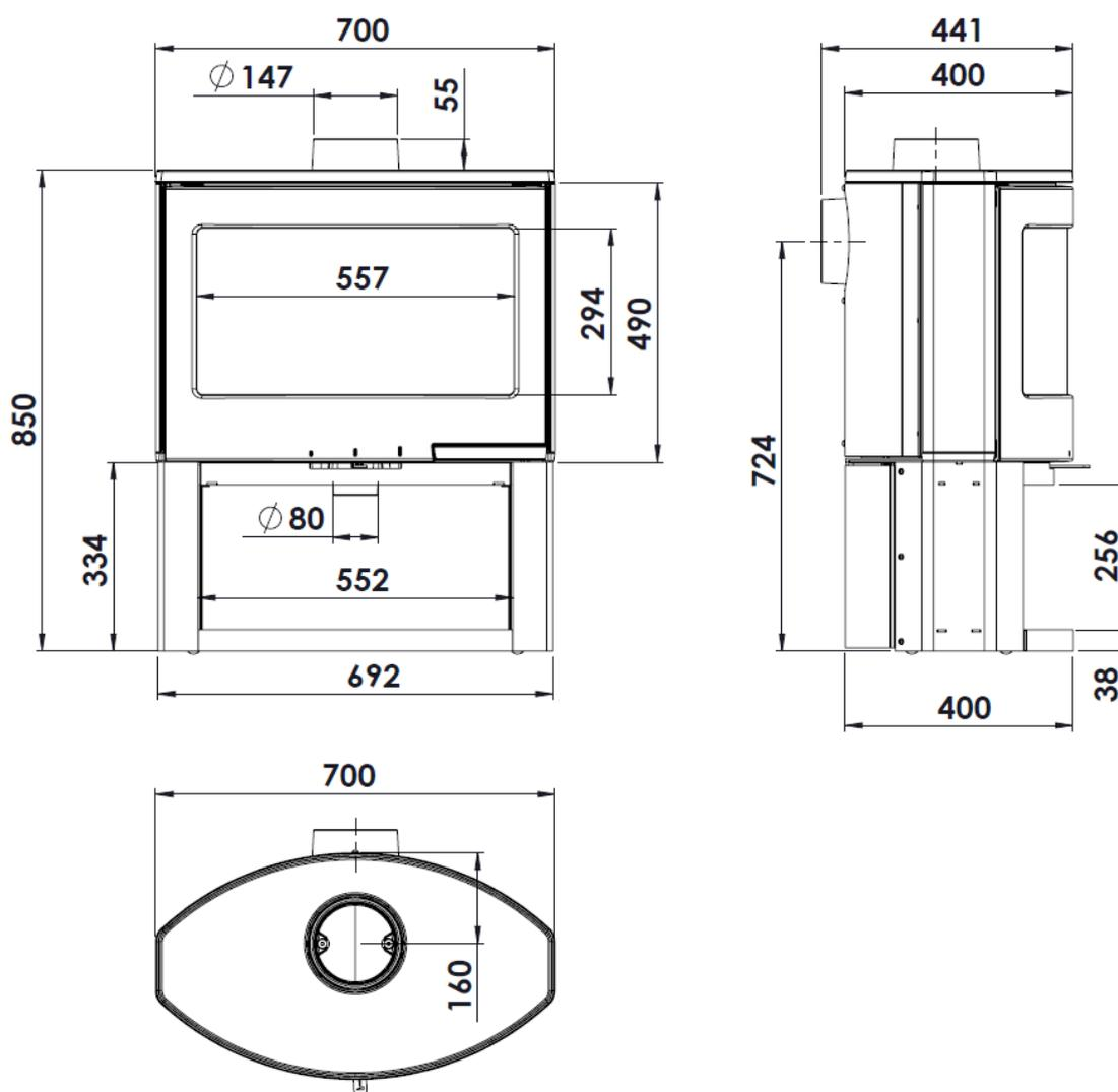
Figura nº1 - Dimensões em mm do aparelho Dublin / Bristol
