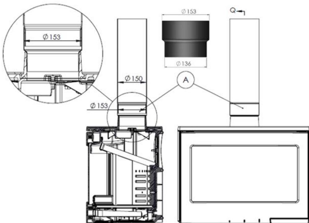
Figura nº4 - Ligação à conduta de fumos com adaptador (A) fornecido
