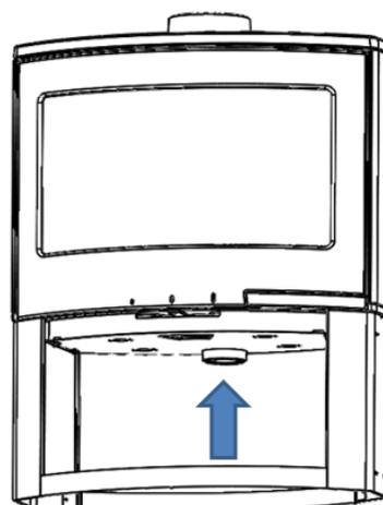
Figura nº11 - Condução de ar para câmara de combustão
