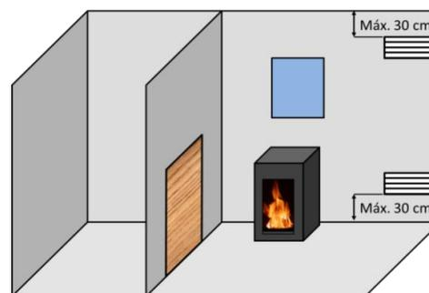
Figura nº5 - Esquema orientativo para grelhas de arejamento
