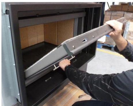
Figura nº41 - Passo intermédio ao rebater
