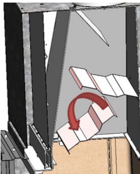
Figura nº31 - Desmontagem do defletor médio Itaca 80 eco
