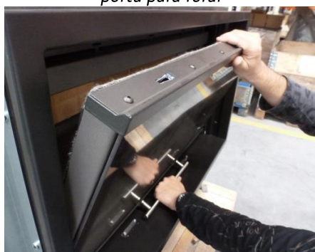
Figura nº42 - Agarra-se na porta firmemente com ambas as mãos enquanto se rebate a mesma
