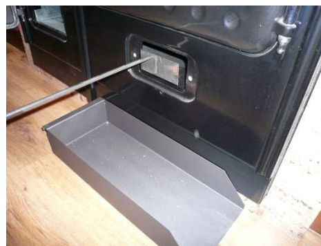
Figura n.º15 - Acessos para a limpeza da saída de fumos.
