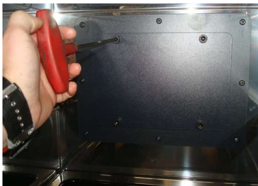
Figura n°16 - Accesso alle viti per rimuovere la copertura del sportello
