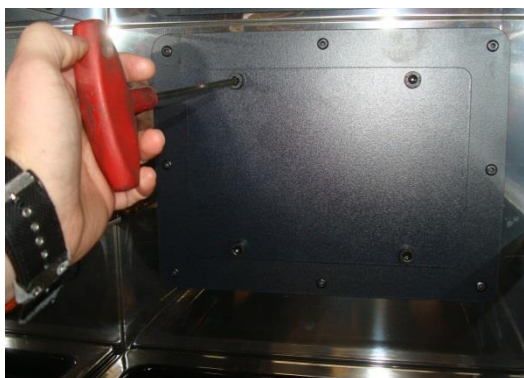
Figura n°21 - Accesso alle viti per rimuovere la copertura del sportello
