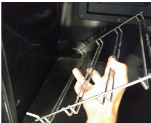
Figura n°23 - Rimozione dei portacanne
