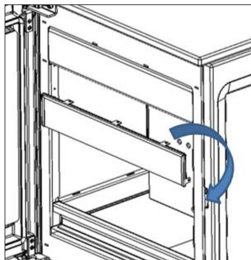
d- Togliere il "separatoro ribaltabile" (7) ruotandolo verso l'interno del focolare.
