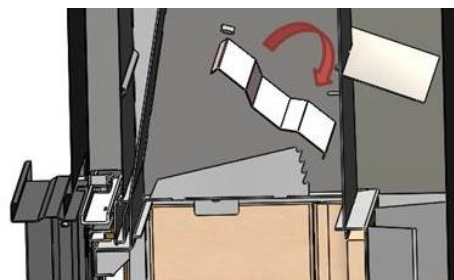
Figura n°26 - Smontaggio del deflettore intermedio Inca
