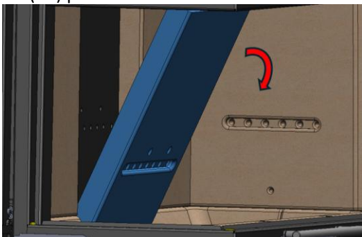
d- Rimuovere la piastra centrale posteriore (5) lasciandola cadere in avanti.
