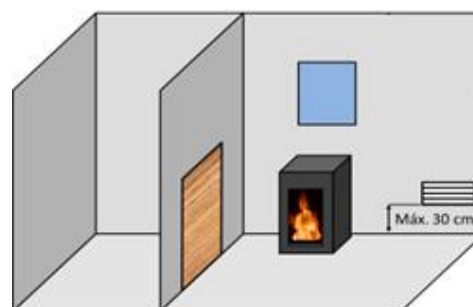
Figura n°11 - Schema orientativo per griglie di ventilazione
