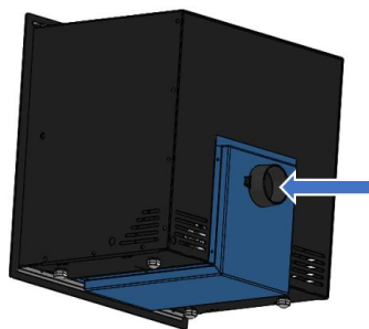
Figura n°13 - Accessorio per incanalare l'ingresso dell'aria dalla parte posteriore
