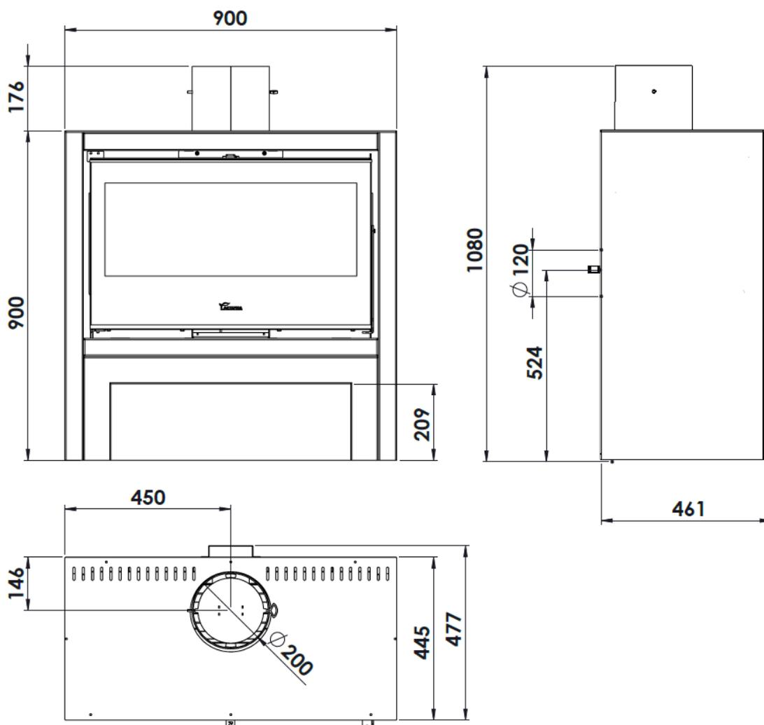
Figura n°1 - Dimensioni in mm dell'apparecchio Platinum 800
