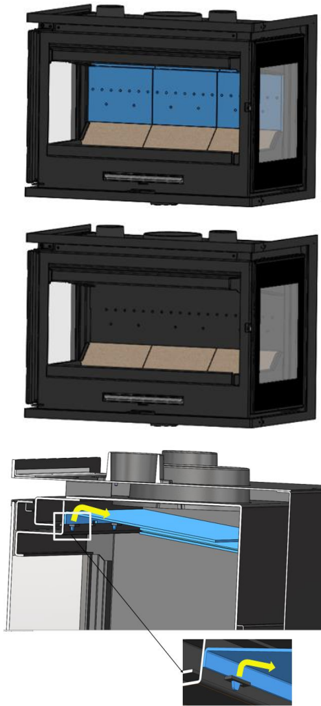
Figure n°9 - Démontage du déflecteur acier
