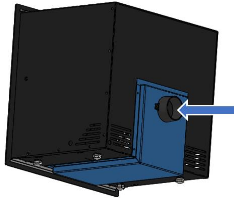
Figure n°14 - Accessoire pour canaliser l'entrée d'air par l'arrière
