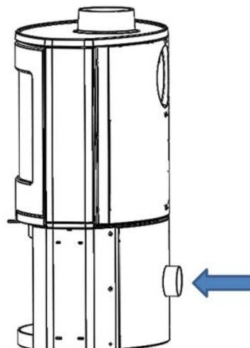
Figure n°12 - OPTION 1 Conduction d'air extérieur
