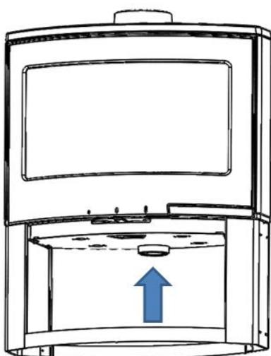
Figure n°11 - Entrée d'air pour la chambre de combustion
