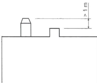
Figure n°14 - Distances depuis le haut du sommet jusqu'au faîtiage du toit
