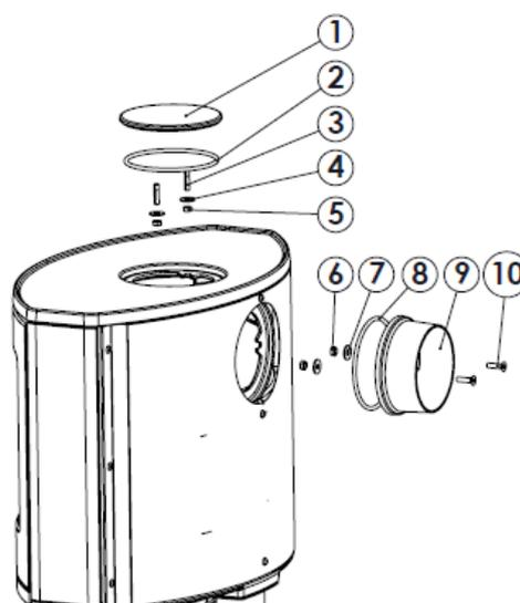
Figure n°10 - Montage du couvercle supérieur et le collier à l'arrière
