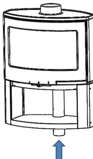
Figure n°13 - OPTION 2 Conduction d'air extérieur
