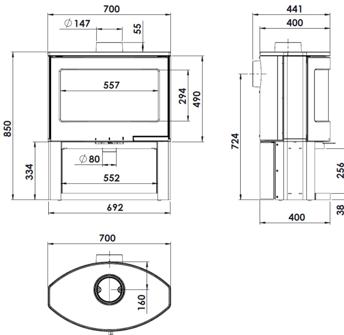
Figure n°1 - Dimensions en mm de l'appareil Dublin / Bristol
