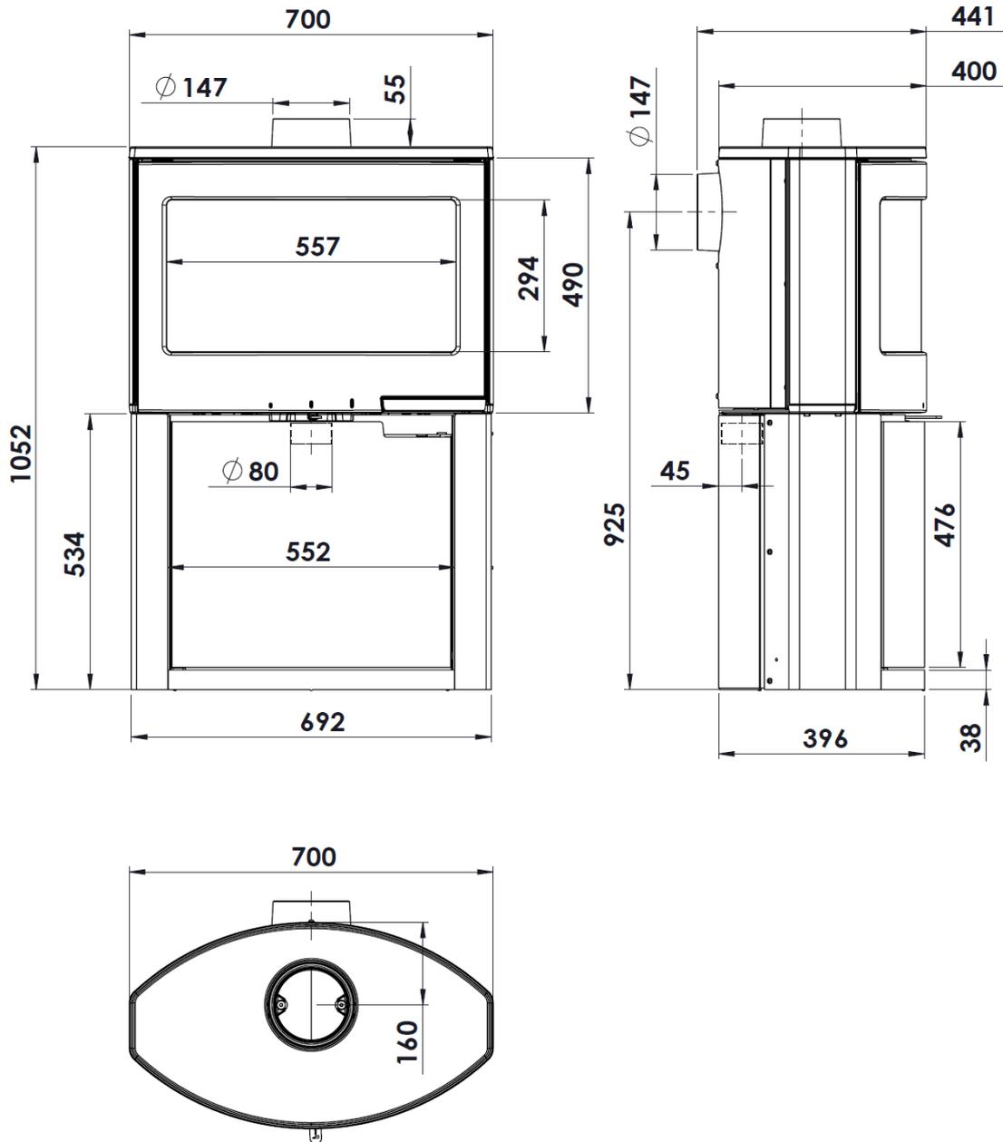
Figure n°2 - Dimensions en mm de l'appareil Bera
