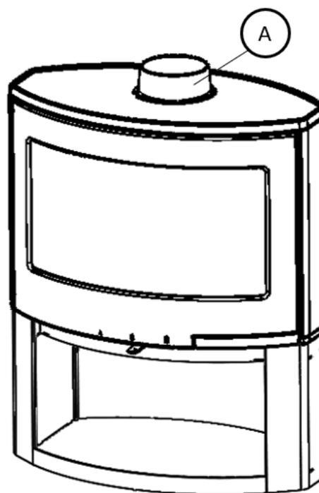
Figure n°8 - Image sortie de fumée supérieure
