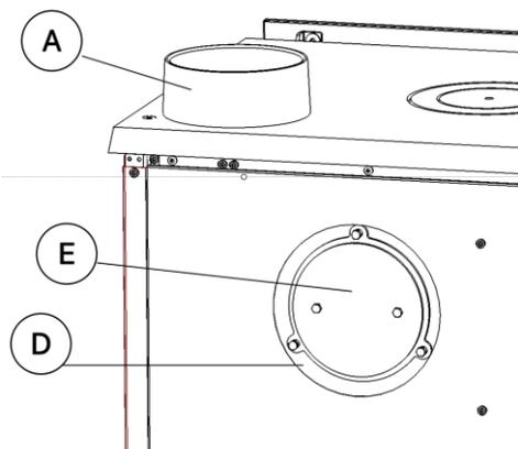
Figure nº 8-Situation finale, adaptée à la sortie de fumée supérieure.
