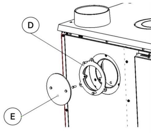
Figura nº10 - Nous plaçons l'adaptateur et le couvercle
