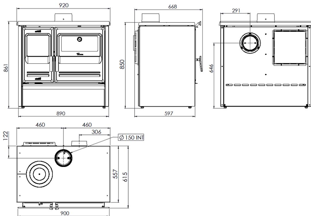
Figura n°5 - Dimensioni in mm de l'appareil ETNA 7T
