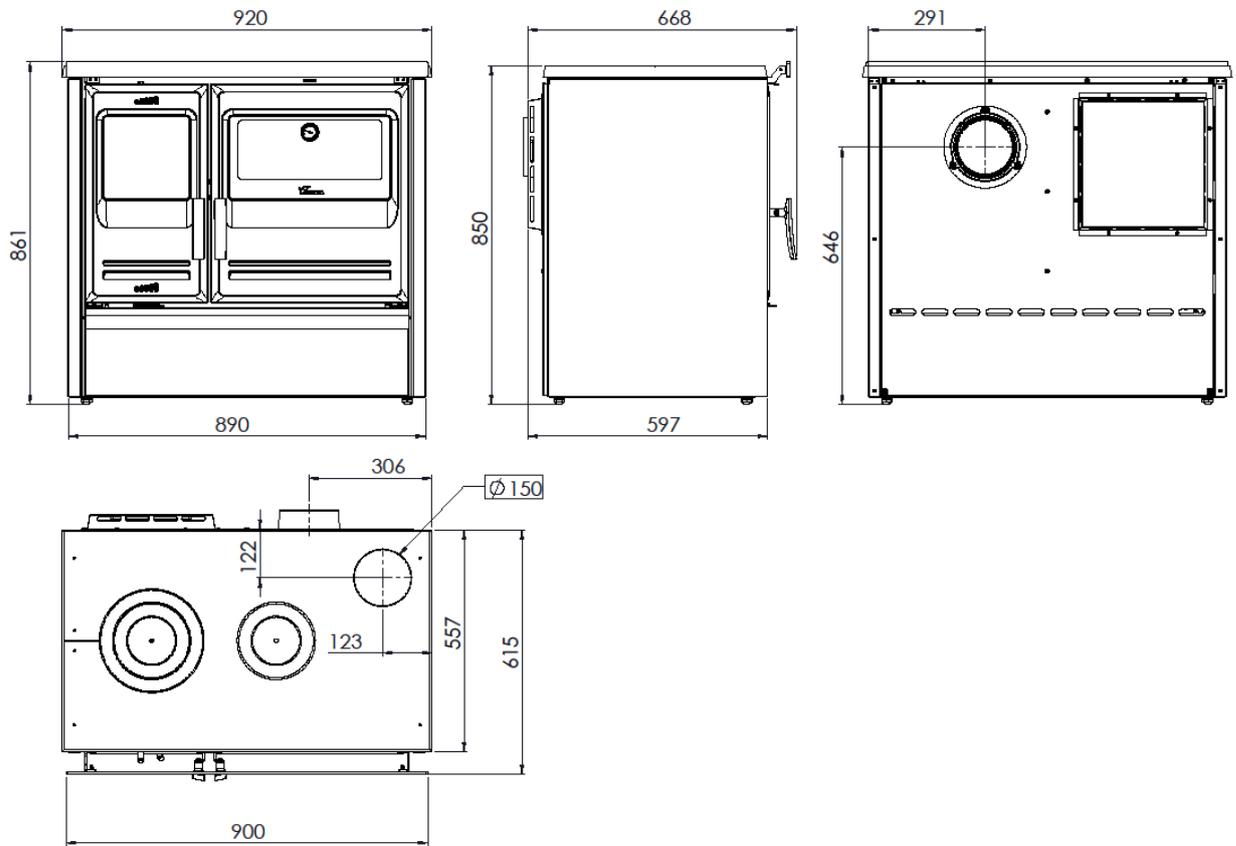
Figura n°4 - Dimensioni in mm de l'appareil ETNA 7T
