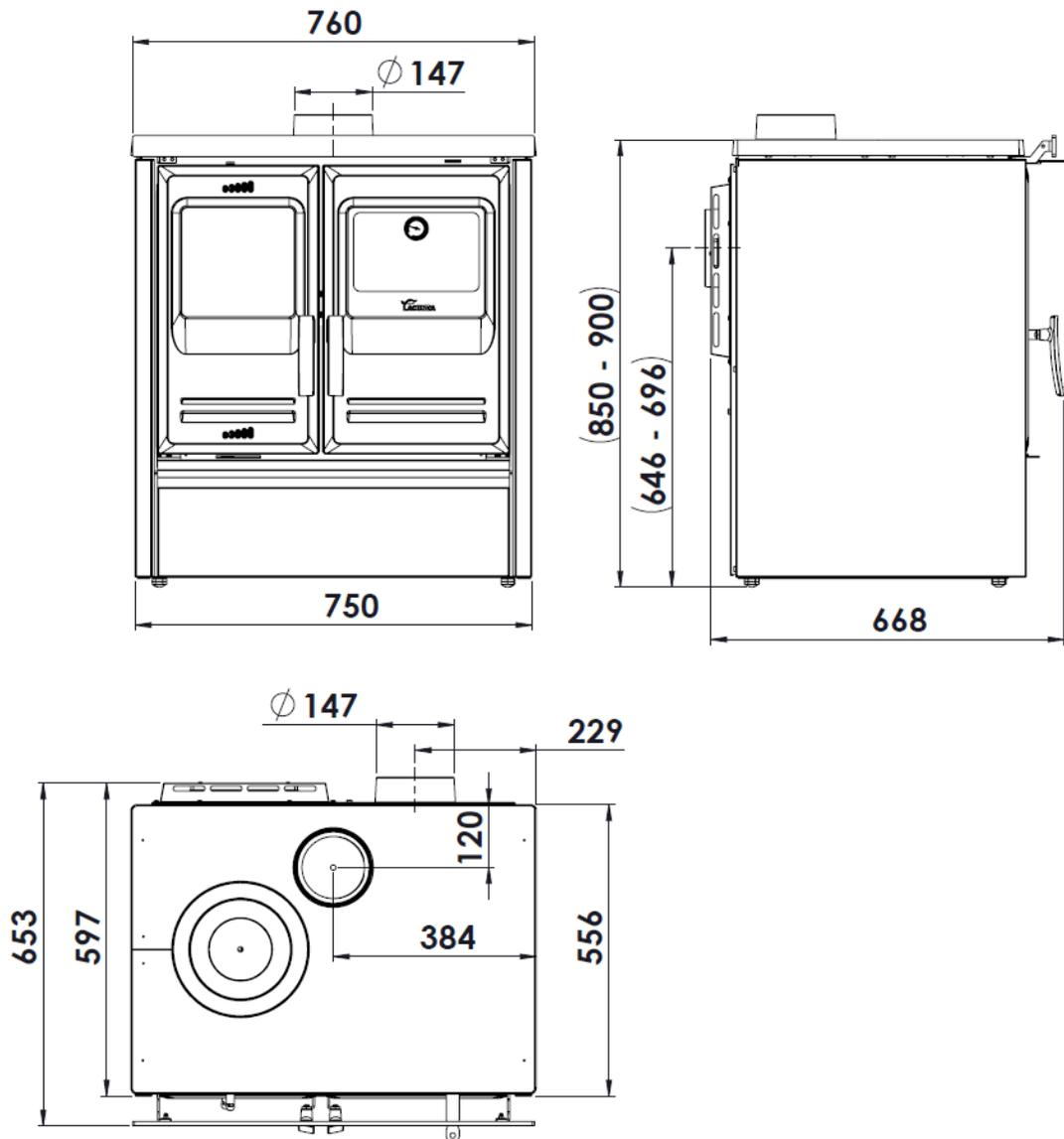
Figura n°1 - Dimensions en mm de l'appareil ETNA 5T
