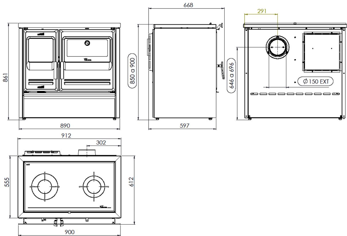
Figura nº3 - Dimensions en mm de l'appareil ETNA 7T TOP
