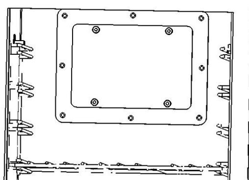
Figura nº16 - Écoutille de la partie arrière du four
