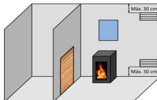
Figura nº6 - Schéma indicatif pour les grilles de ventilation
