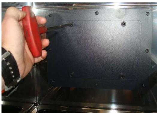
Figure n°16 - Accès aux vis pour retirer le couvercle de la trappe
