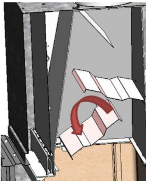
Figure n°32 - Démontage du déflecteur supérieur Itaca 80
