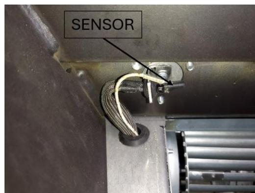
Figure n°22 - Position de la sonde de température (SENSOR) dans la sortie d'air chaud
