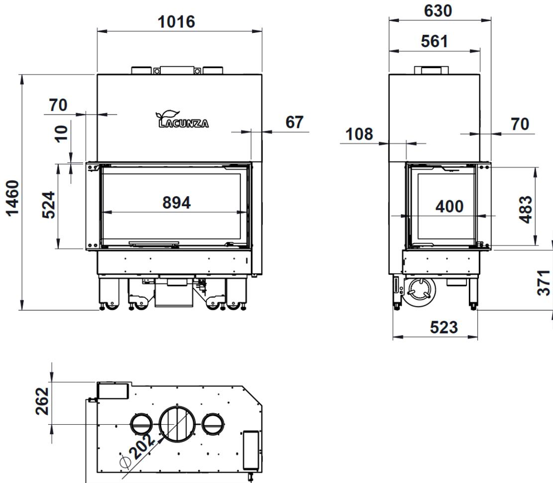
Figure n°2 - Dimensions en mm de l'appareil IZARO 100 CLI
