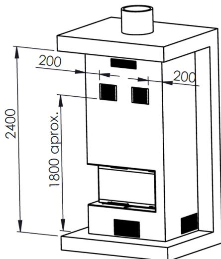
Figure n°10 - Schéma extérieur de la fermeture
