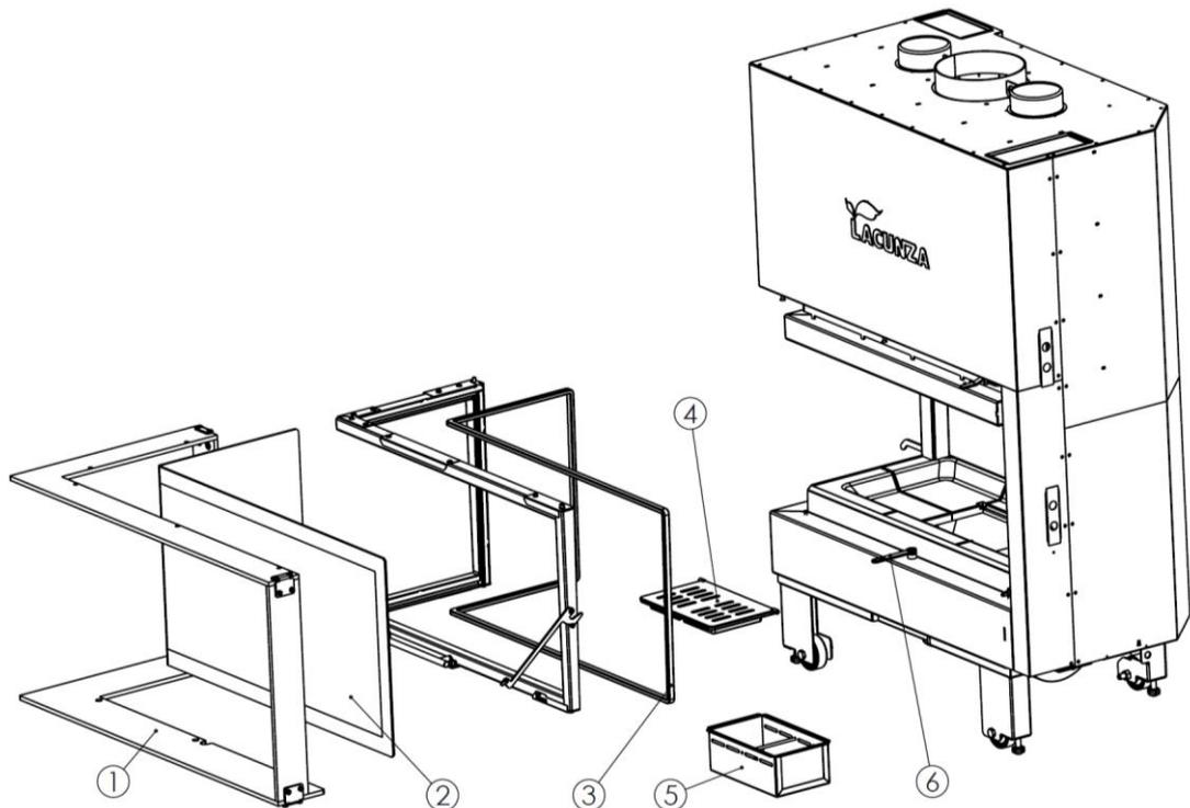
*Figure n°48 - Pièces détachées Izaro 80-100 CLI*
