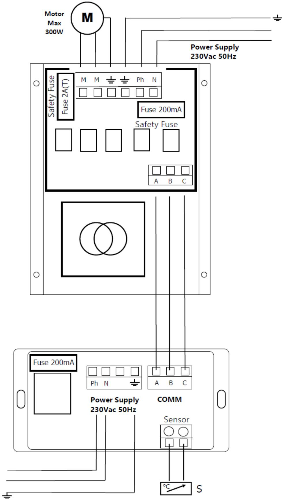
Figure n°20 - Branchements à effectuer dans le contrôleur et le module de puissance de Izaro C/V
