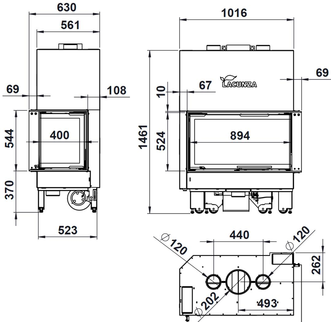
Figure n°4 - Dimensions en mm de l'appareil IZARO 100 CLD
