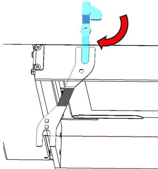
Figure n°41 - Tournez le levier supérieur gauche dans le sens des aiguilles d'une montre de 90°
