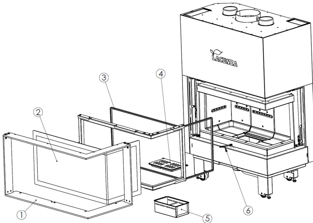
Figure n°51 - Pièces détachées Izaro 80-100 CLD
