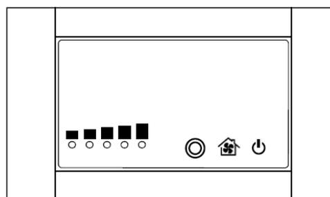
Figure n°45 - Display du régulateur d'air automatique / manuel
