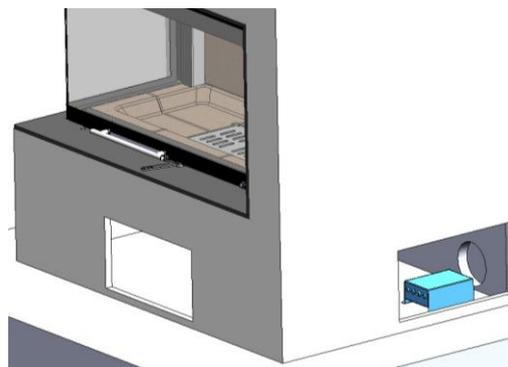
Figure n°23 - Positionnement du module de puissance devant la grille de ventilation latérale
