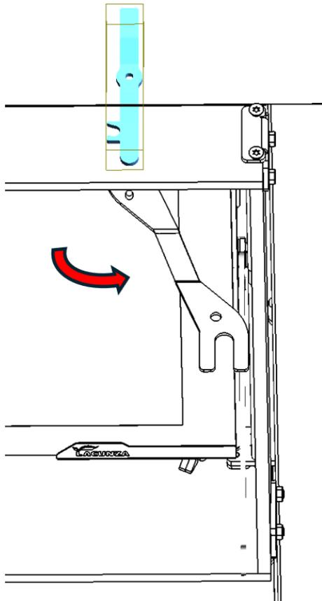
Figure n°40 - Tournez le levier de 90° dans le sens inverse des aiguilles d'une montre.
