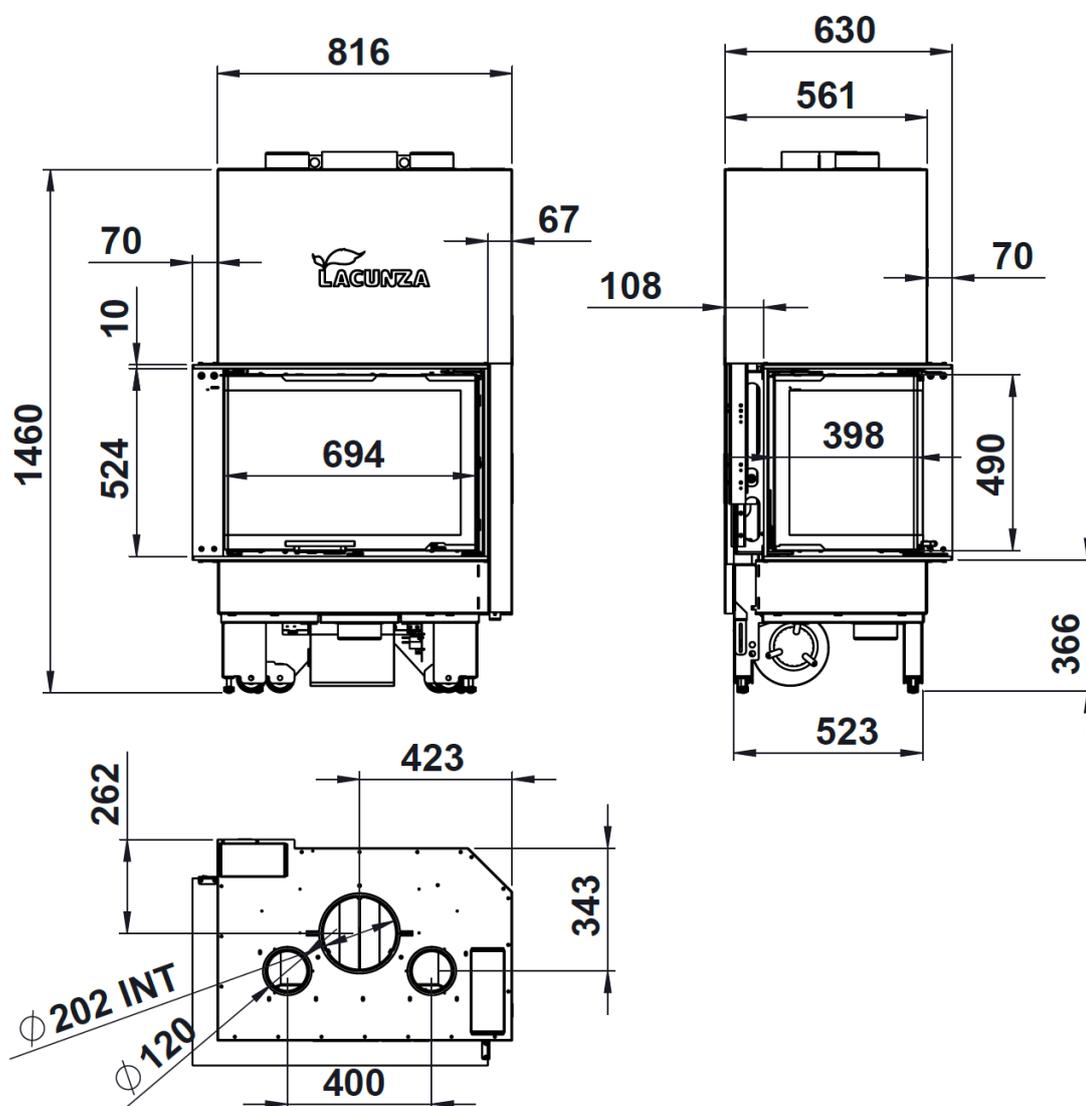
Figure n°1 - Dimensions en mm de l'appareil IZARO 80 CLI
