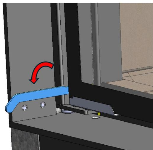
Une fois les trois leviers tournés, la porte sera bloquée pour le mouvement vertical (mode guillotine) et pourra s'ouvrir horizontalement en tournant sur les axes situés sur le côté de la porte.
