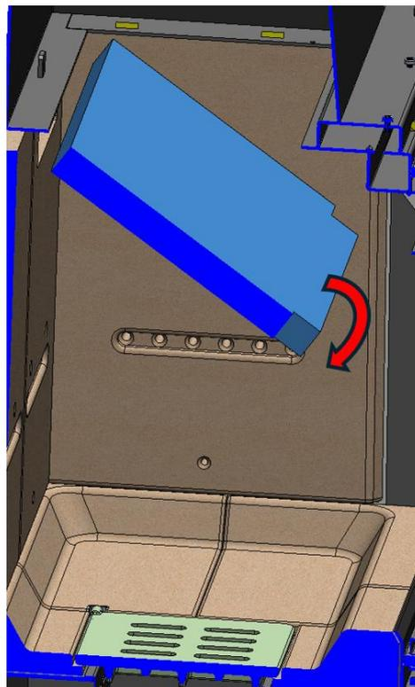
Figure n°37 - Démontage du déflecteur supérieur Iزارو 100 CLI
