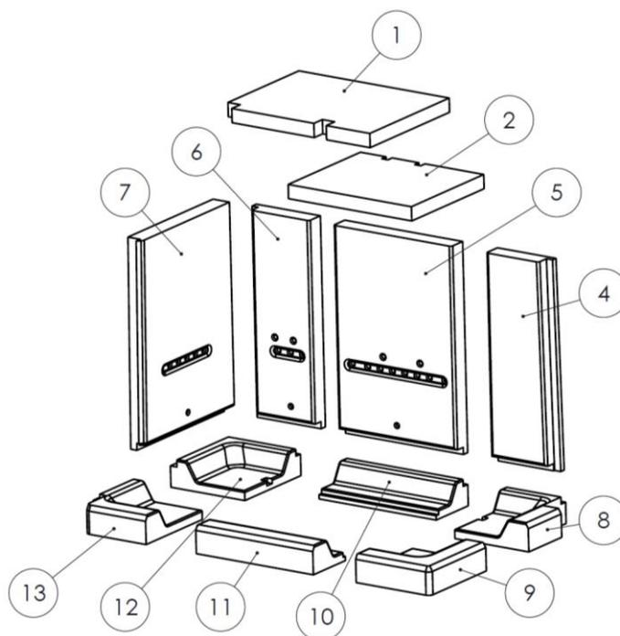
Figure n°52 - Pièces détachées Izaro 80 CLD
