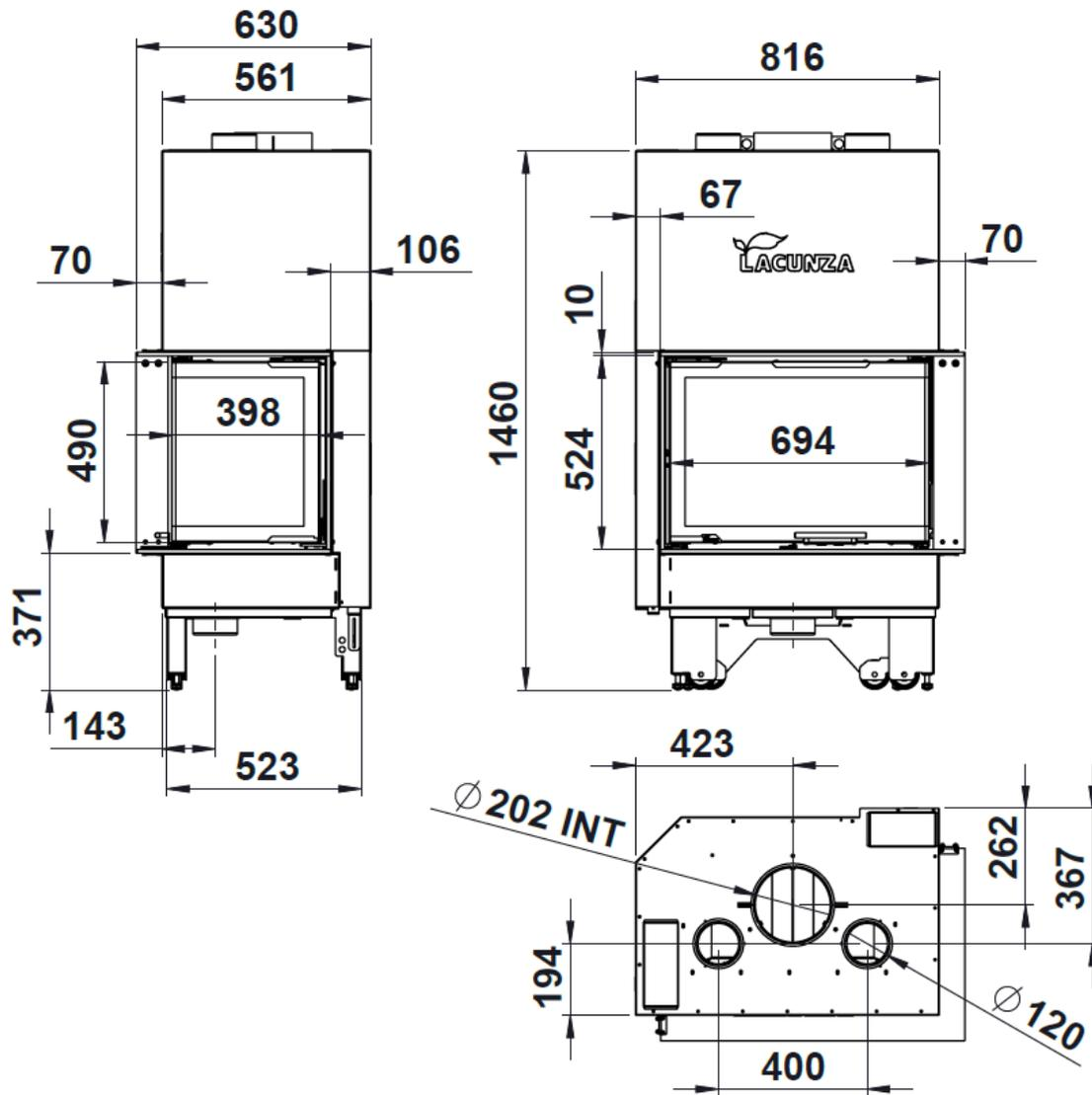
Figure n°3 - Dimensions en mm de l'appareil IZARO 80 CLD
