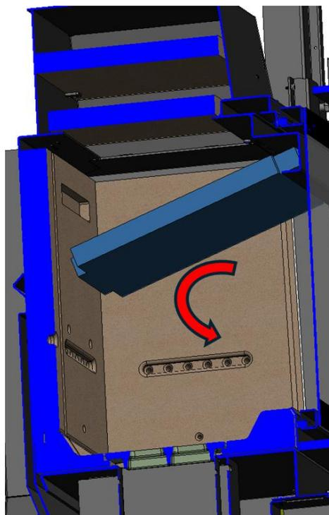
Figure n°35 - Démontage du déflecteur inférieur Izaro 100 CLI
