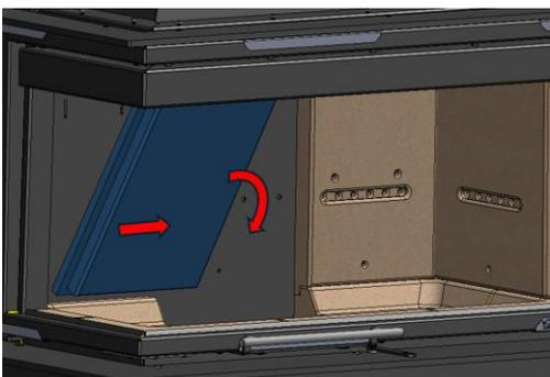
e- Retirez la plaque arrière gauche (4) en la déplaçant vers l'intérieur et en la laissant tomber vers l'avant.
