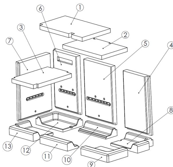
Figure nº53 - Pièces détachées foyer Izaro 100 CLD
