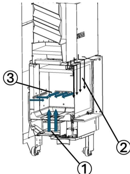
Figure n°32 - Entrées d'air de combustion
