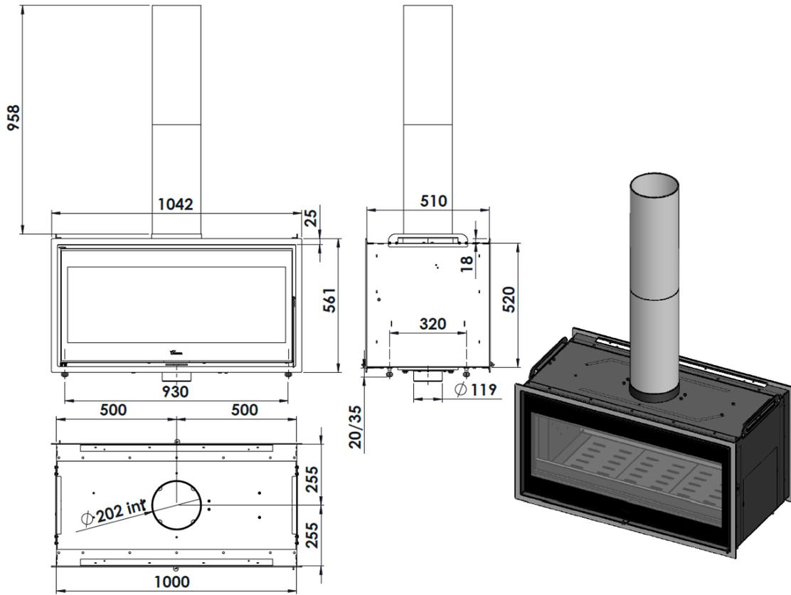
Figure n°3 - Dimensions en mm de l'appareil Nickel 1000
