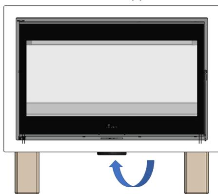
Figure n°5 - Entrée d'air pour la combustion
