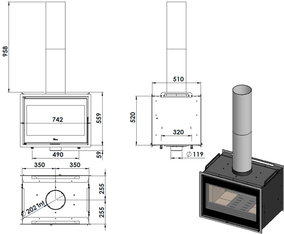
Figure n°1 - Dimensions en mm de l'appareil Nickel 700
