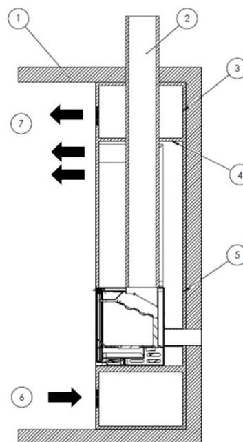
Figure n°7 - Schéma intérieur de la fermeture
