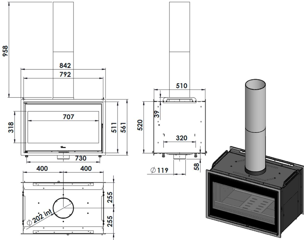
Figure n°2 - Dimensions en mm de l'appareil Nickel 800
