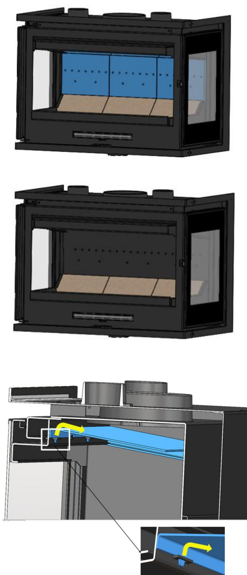
Figure n°23 - Démontage du déflecteur acier
