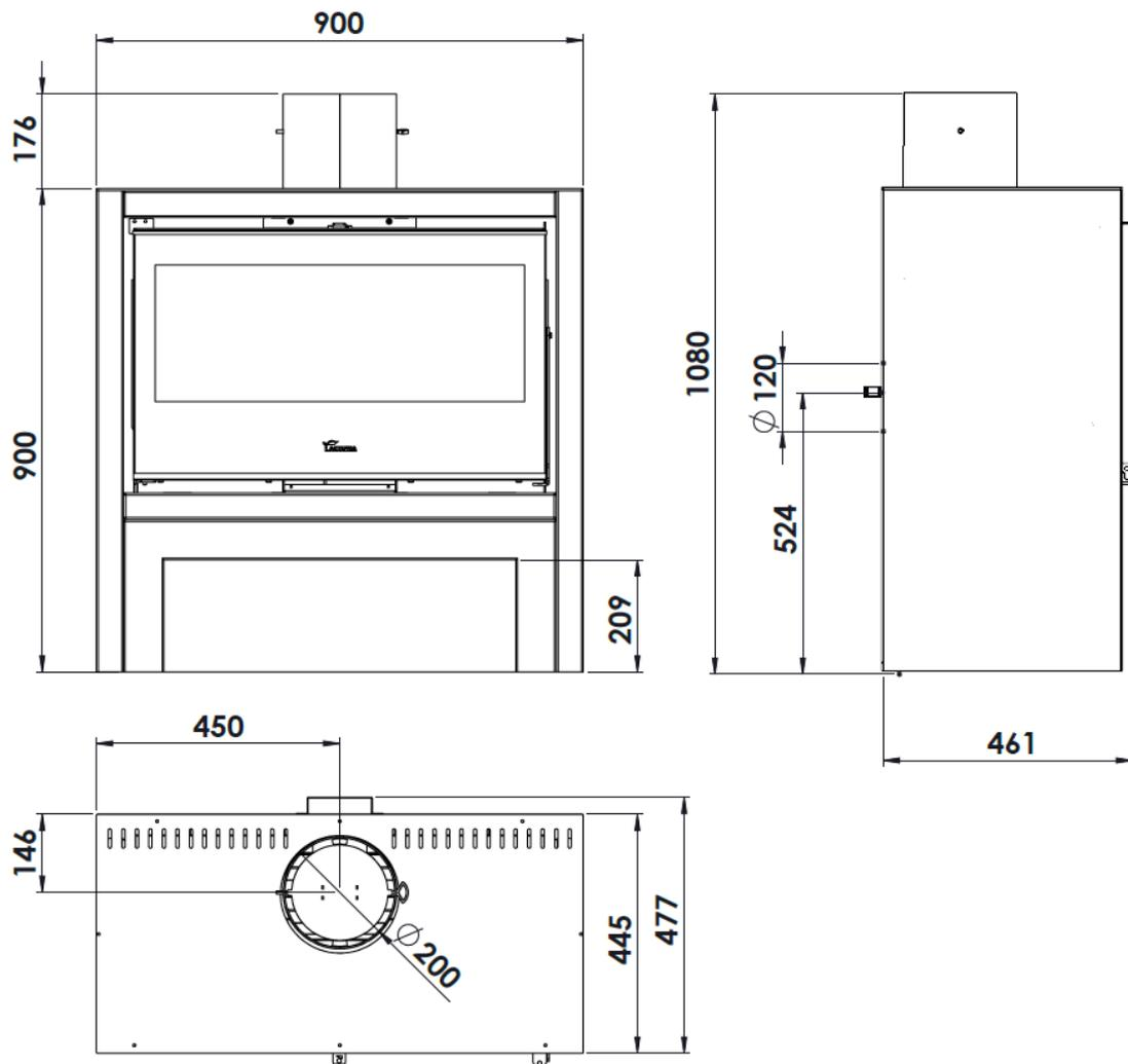
Figure n°1 - Dimensions en mm de l'appareil PLATINUM 800
