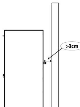
Figure n°3 - Distance entre l'appareil et le mur arrière
