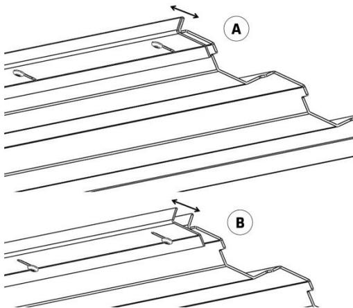
Figure n°9 - Différentes positions du déflecteur inférieur Platinum 800
